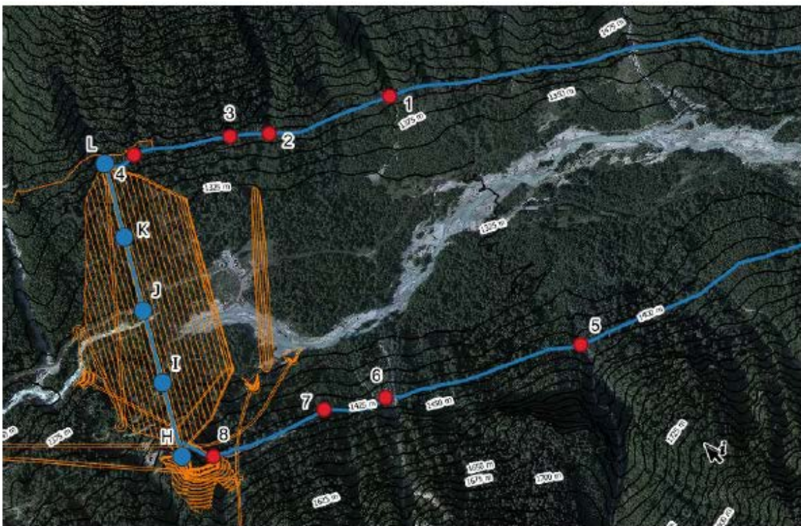
ნახაზი 19: მოხდა 1-დან 8 ლოკაციამდე წარმოქმნილი იმპულსური ტალღების ადმასვლის ანალიზი, რომელიც წარმოიქმნება კაშხალთან H-დან L წერტილამდე.
