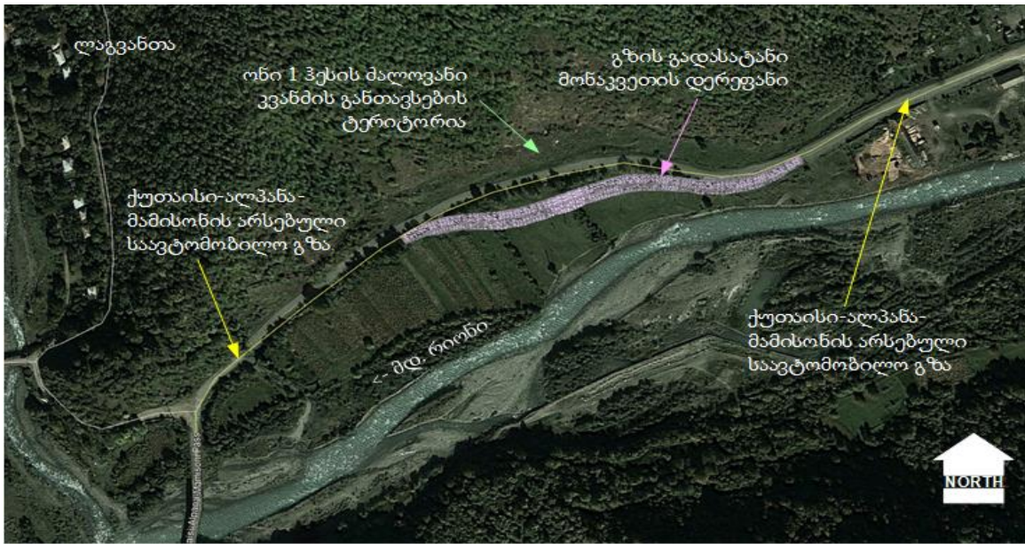
სურათი 2.4.3.2. ონი 1 ჰესის სათავე ნაგებობის განთავსების ტერიტორიის მიმდებარედ დაგეგმილი საავტომობილო გზის გადატანის სქემა
