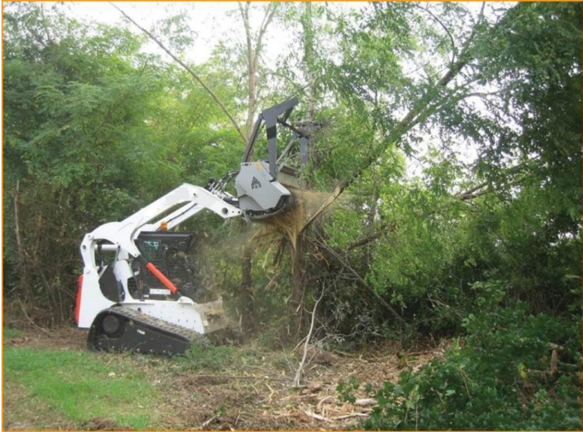
ნახ. 10.4.2 დიდი და მცირე ზომის სამშენებლო ტექნიკაზე დამონტაჟებული მცენარეული მასის დამაქუცმაცებლები
