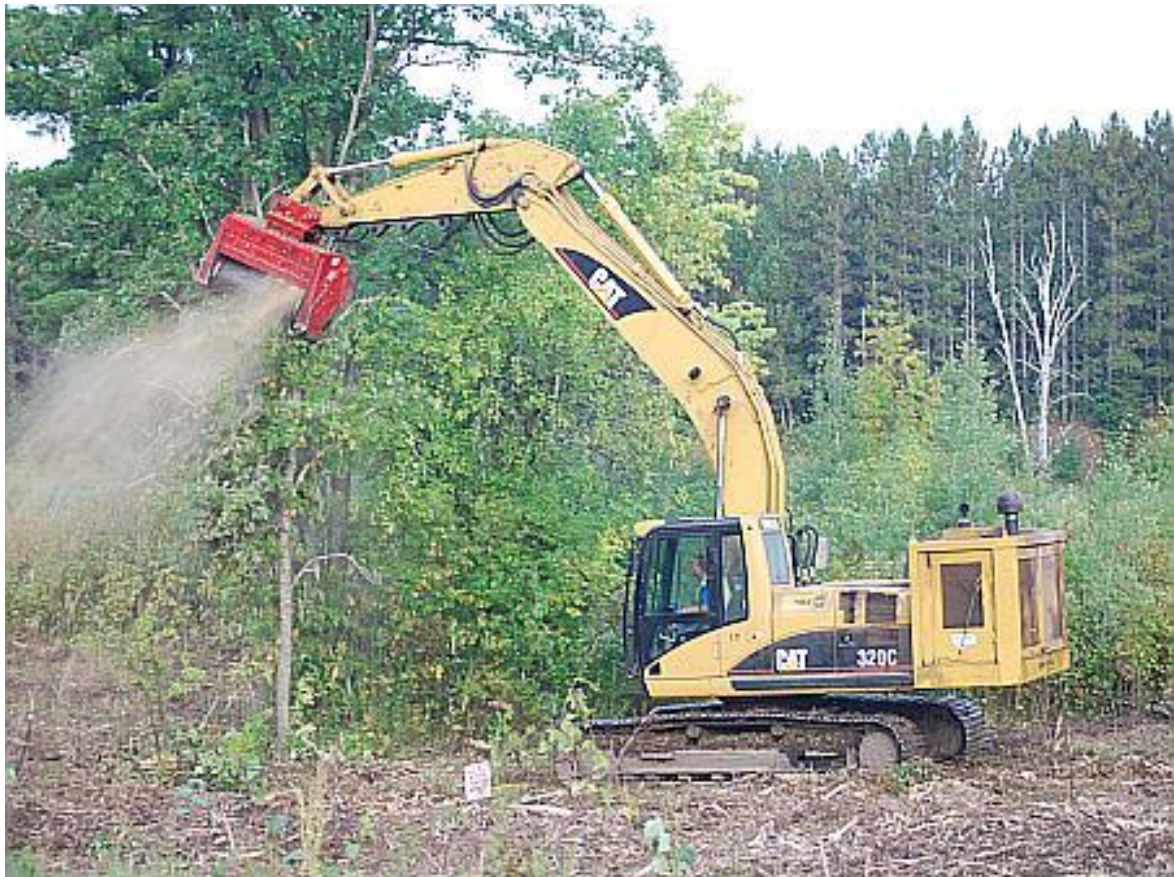
ნახ. 10.4.1 მცენარეების დასაქუცმაცებელი დანადგარების მაგალითები
