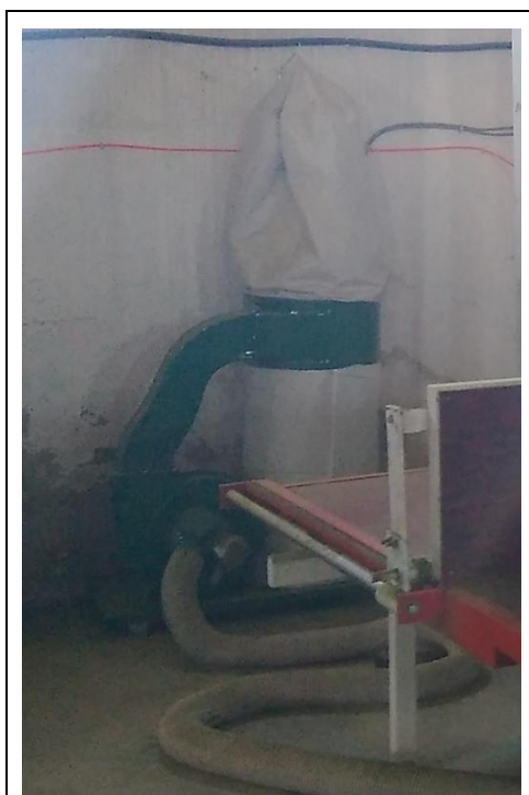
სურათი 4.12. მექანიკური ვერტიკალური მჭრელი დანადგარის ასპირაციული მოწყობილობა და ერთ ტომრიანი მტვერდამჭერი აგრეგატი
