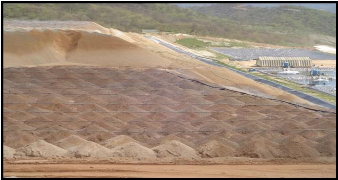
სურ. 3. გამოტუტვა-მეორად კვარციტებზე ნატრიციანიდური ხსნარის დასხურება
