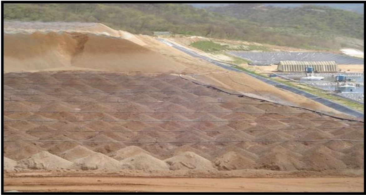
სურ. 3. გამოტუტვა-მეორად კვარციტებზე ნატრიციანიდური ხსნარის დასხურება
