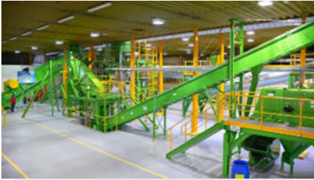
ფოტო 2: ხმარებიდან ამოღებული სამაცივრე დანადგარების დამუშავების ტექნოლოგია კომპანიაში ElektroRecycling, Slovenská Ľupča, სლოვაკეთი
