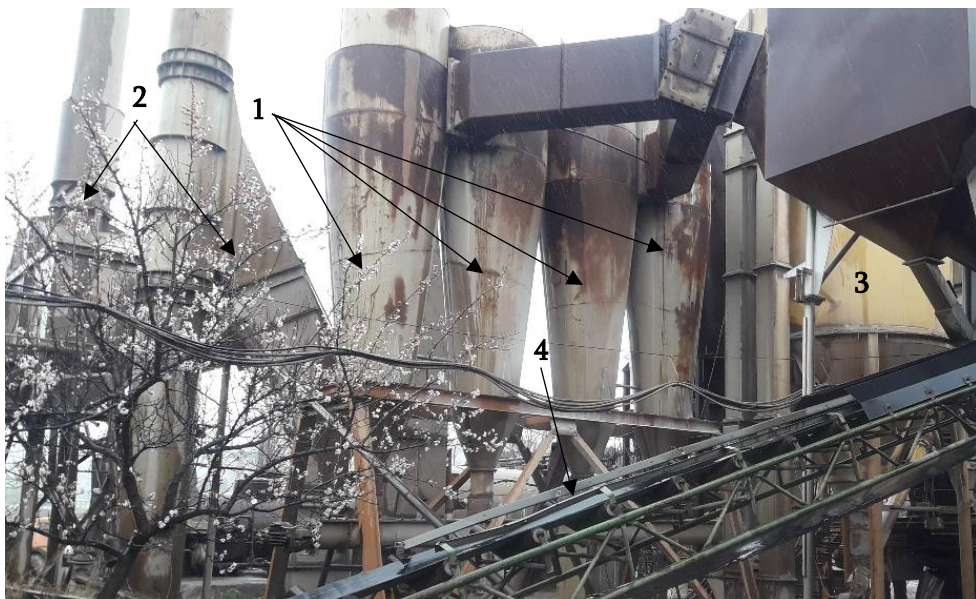
ნახ. 2.6 შპს „დი აი კაპიტალი“-ს ასფალტის ქარხნის აირმტვერგამწმენდი სისტემა.
