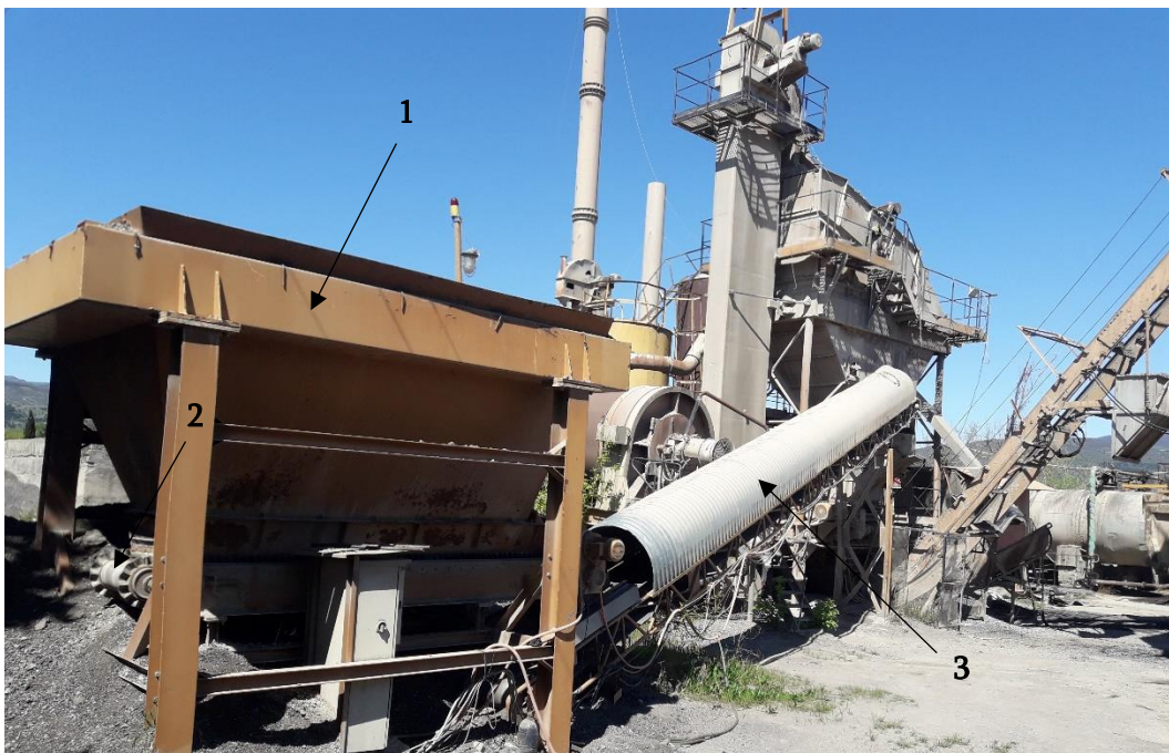
ნახ. 2.7 შპს „დი აი კაპიტალი“-ს ასფალტის საწარმოს მეორადი ნედლეულით მომარაგების სისტემა.
