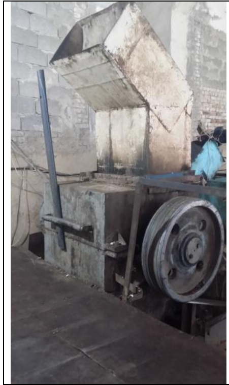
სურათი 4.2. პლასტმასის ნარჩენების როტორული დამჭეცმაცხებელი
