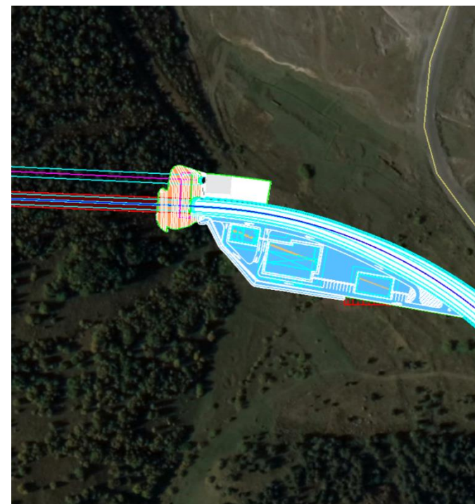
ნახაზი 83. გვირაბის ჩრდილოეთ პორტალთან არსებული GOGC-ს გაზსადენის მილები (pk22+020- 22+120; pk22+100- 22+170)
