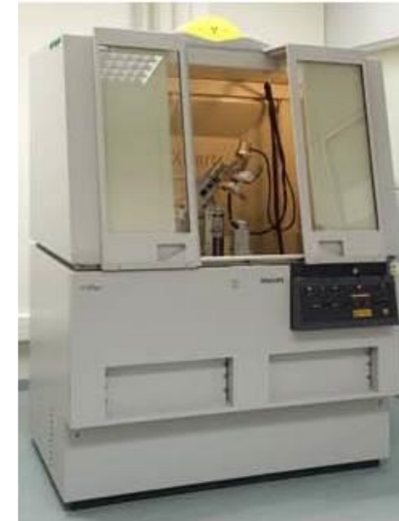
ფიგურა 7. რენდგენოსტრუქტურული დიფრაქტომეტრი (X-ray diffractometer) Philips X'Pert Pro, ოვიდეოს უნივერსიტეტი Oviedo University.
