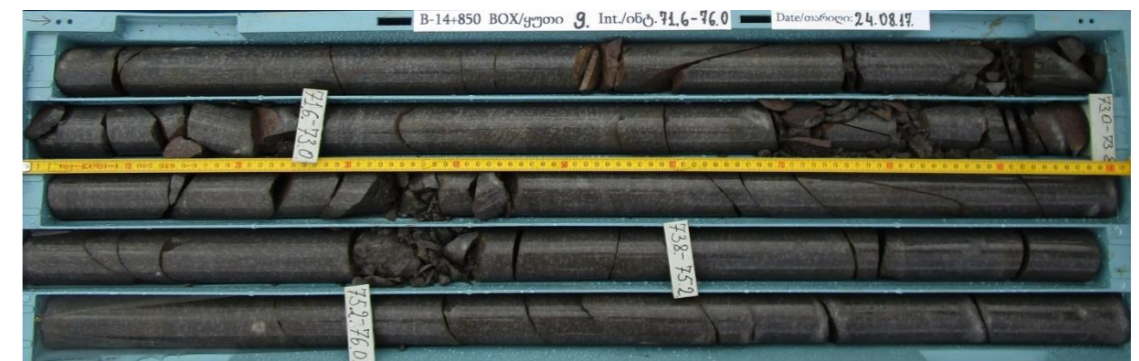
ფიგურა 58. პაჰოეჰოეს ტიპის ლავები (Qv1) გაშიშვლებაზე, წვერესთან ახლოს (გვირაბის შესასვლელ პორტალთან) და ჭაბურღილში B-14+850.
