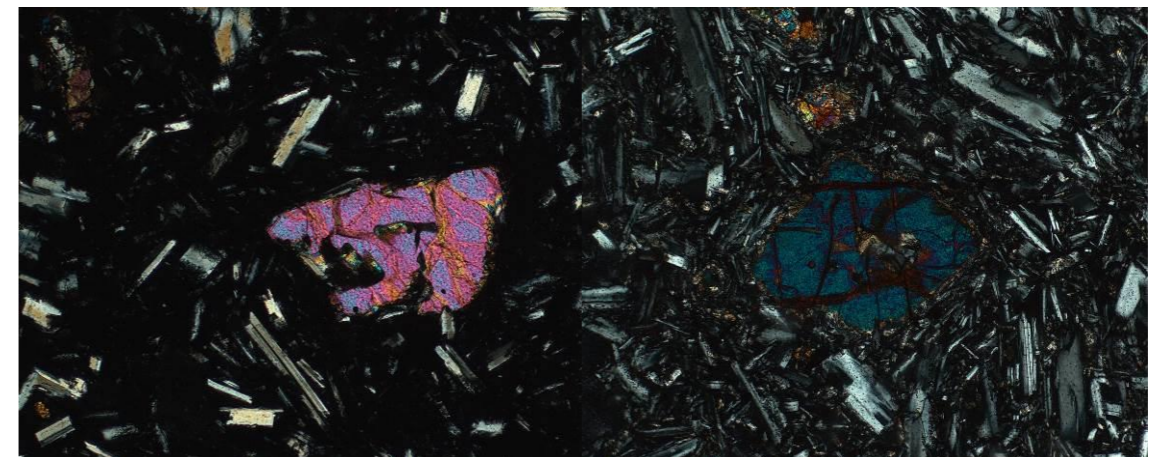
ფიგურა 86. ოლივინის ზაზალტის განსვავებული მახასიათებლები. მარცხნივ, ნიმუში ჭაბურღილიდან B-14+850, პოლარიზებულ შუქში; ოლივინი.
