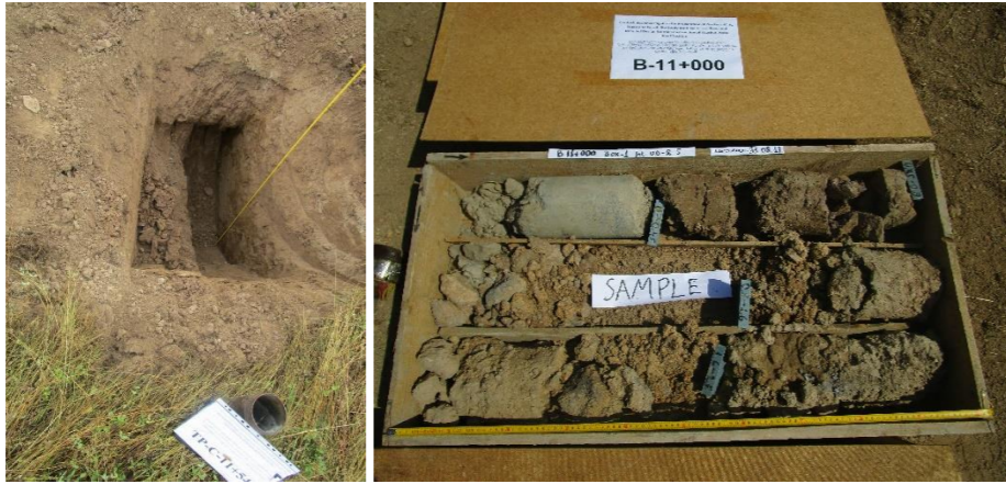
ფიგურა 54. ნარჩენი გრუნტი, აღებული შურფიდან - TP-11+540 და ჭაბურღილიდან B-11+000.
