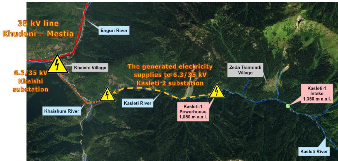
ნახაზი 3.9.2. ალტერნატივა 2: კასლეთი 1 უკავშირდება კასლეთი 2 ჰესს და შემდეგ უკავშირდება ხაიშის ქვესადგურს
