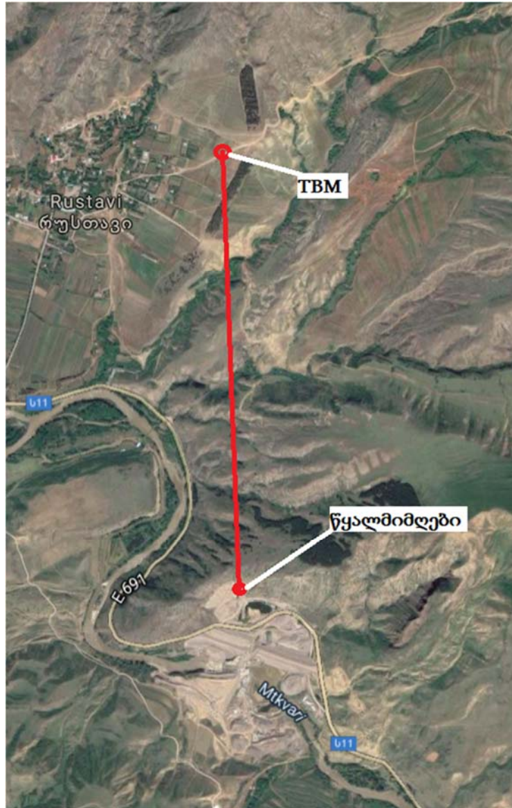
სურათი 2.2. გვირაბგამყვანი მანქანის ამჟამინდელი განთავსების ადგილის და გვირაბის გასაყვანი მონაკვეთის განლაგების სქემა
