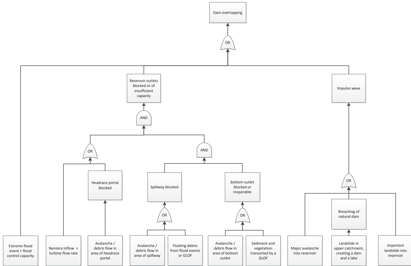
ნახაზი 18 – პრობლემების დიაგრამა, რომლებიც იწვევენ კაშხალზე წყლის გადავლებას ექსპლუატაციის დროს
