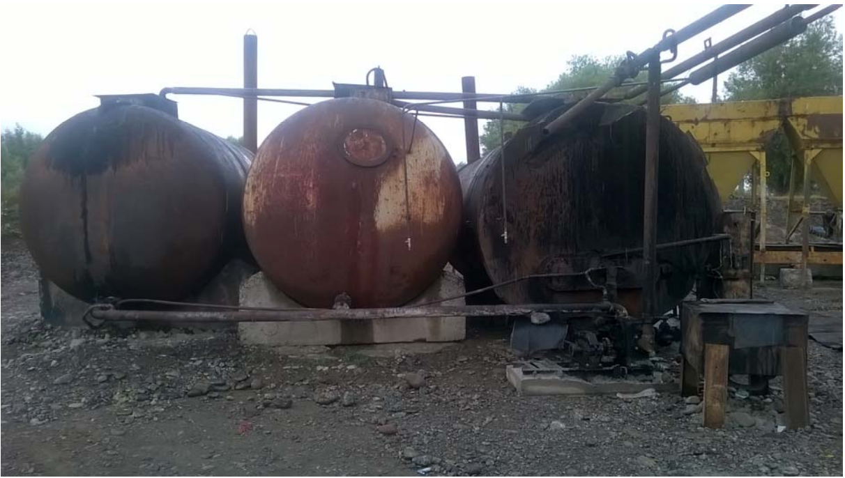
სურათი № 3.1.1. ბიტუმის გამაცხელებელი სანთურები გაფრქვევის მილით
