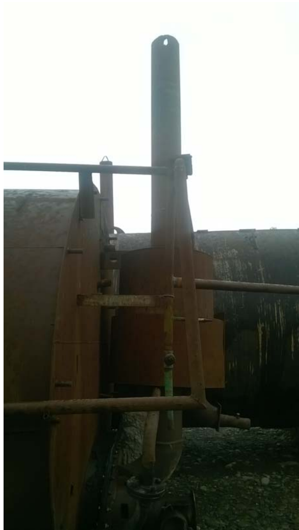
სურათი № 2.2.2. ბიტუმის გამაცხელებელი სათურები გაფრევევის მილით
