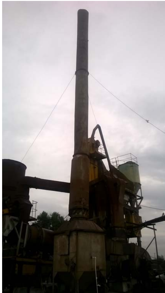
სურათი № 2.2.3. უკრაინული „KREMENCHUG-ДC 158” ტიპის ასფალტის აგრეგატი
