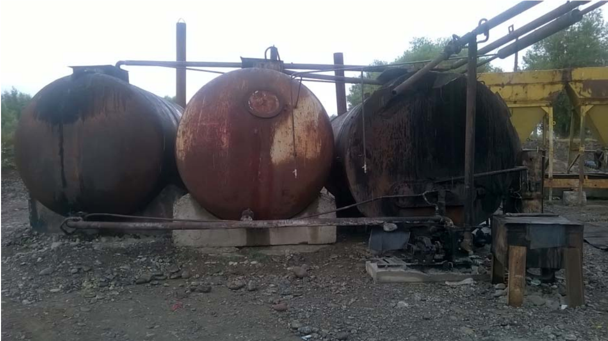
სურათი № 2.2.2. ბიტუმის გამაცხელებელი სათურები გაფრევევის მილით
