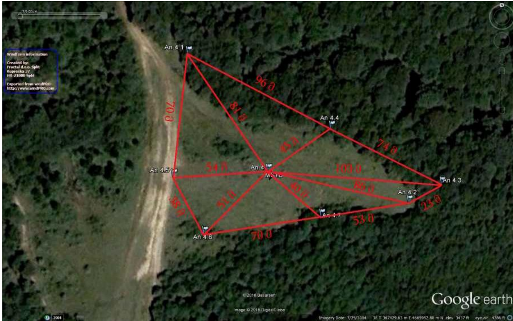
სურათი 5-24 ტერიტორია აეროფოტოზე, სადაც დაგეგმილია მეოთხე ანძის (An 4) განთავსება. მითითებულია რამდენიმე წერტილი ანძიდან მინიმუმ 50 მეტრიანი დაშორებით
