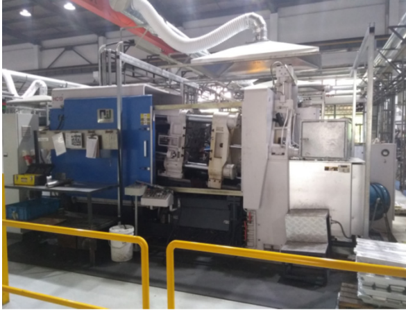
მაღალი წნევის ჩამოსხმის დანადგარი მაღალტემპერატურული კამერით (სადნობი ლუმელი განთავსებულია უშუალოდ დანადგარში)
