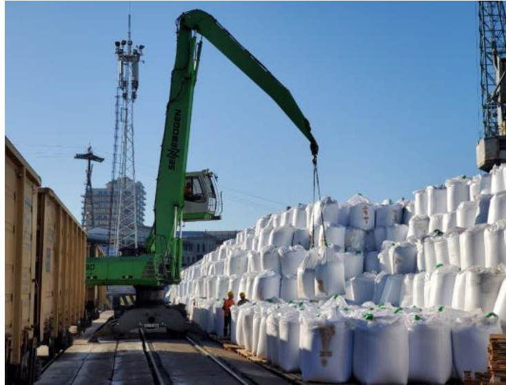
სურათი 2.3.1.2. „Zennebogen“-ის მარკის მობილური ამწეთი ბიგ-ბეგების ჩამოტვირთვა ვაგონებიდან
