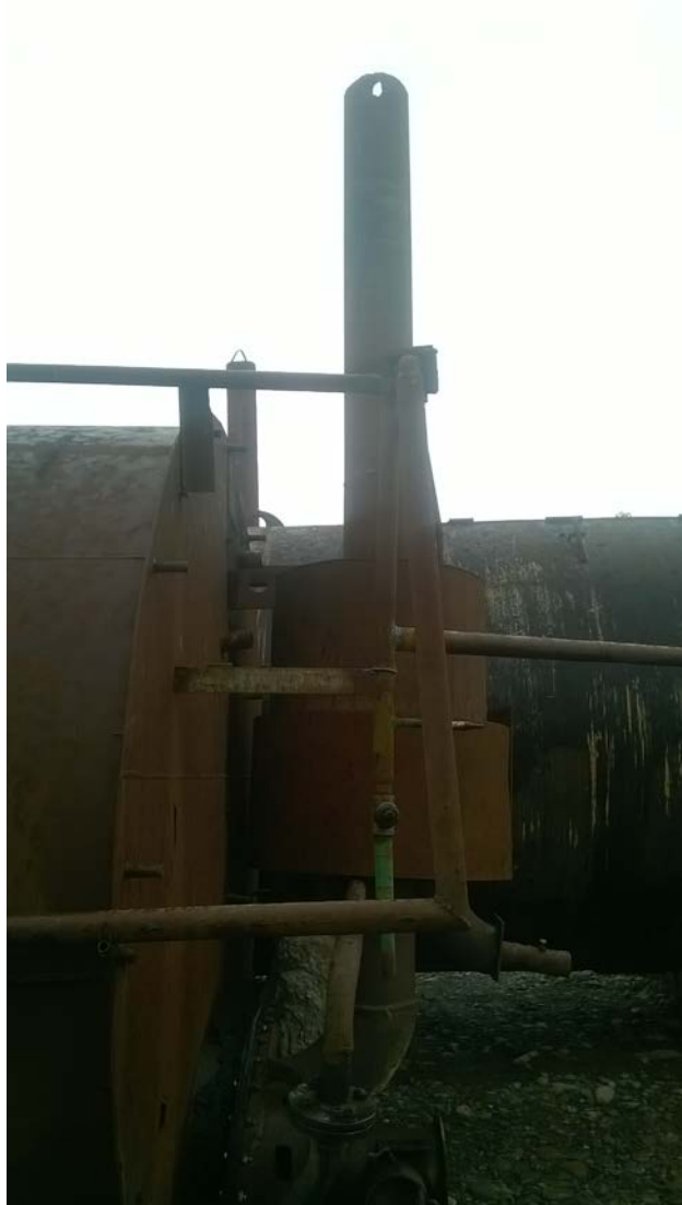
სურათი № 2.2.2. ბიტუმის გამაცხელებელი სანთურები გაფრეკვის მილით
