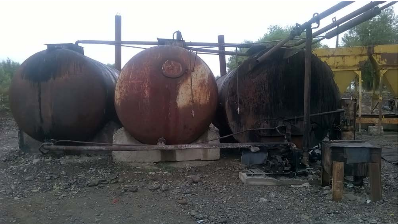
სურათი № 2.2.2. ბიტუმის გამაცხელებელი სანთურები გაფრეკვის მილით
