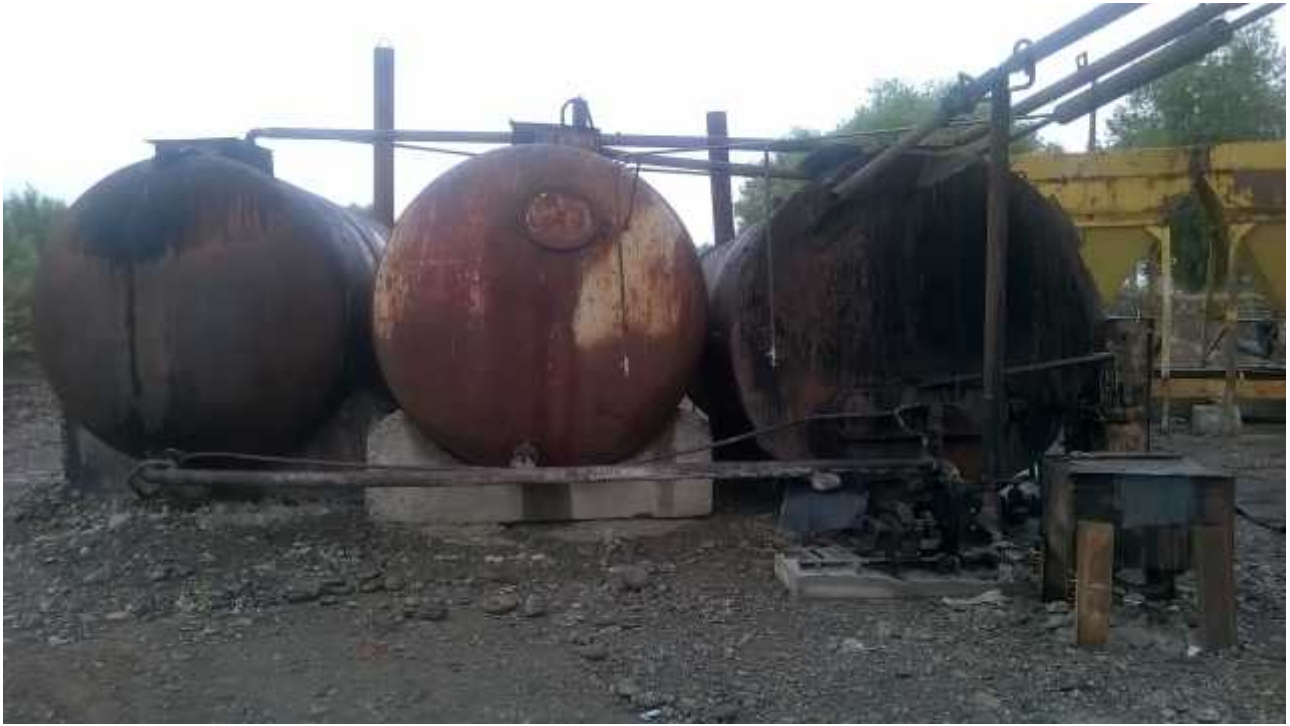
სურათი № 3.1.1. ბიტუმის გამაცხელებელი სანთურები გაფრქვევის მილით
