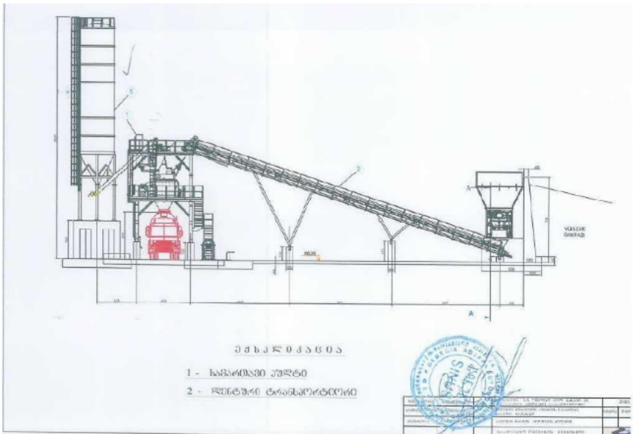
ნახაზი 3.1.2.2. დაგეგმილი ბეტონის კვანძის გვერდხედი
