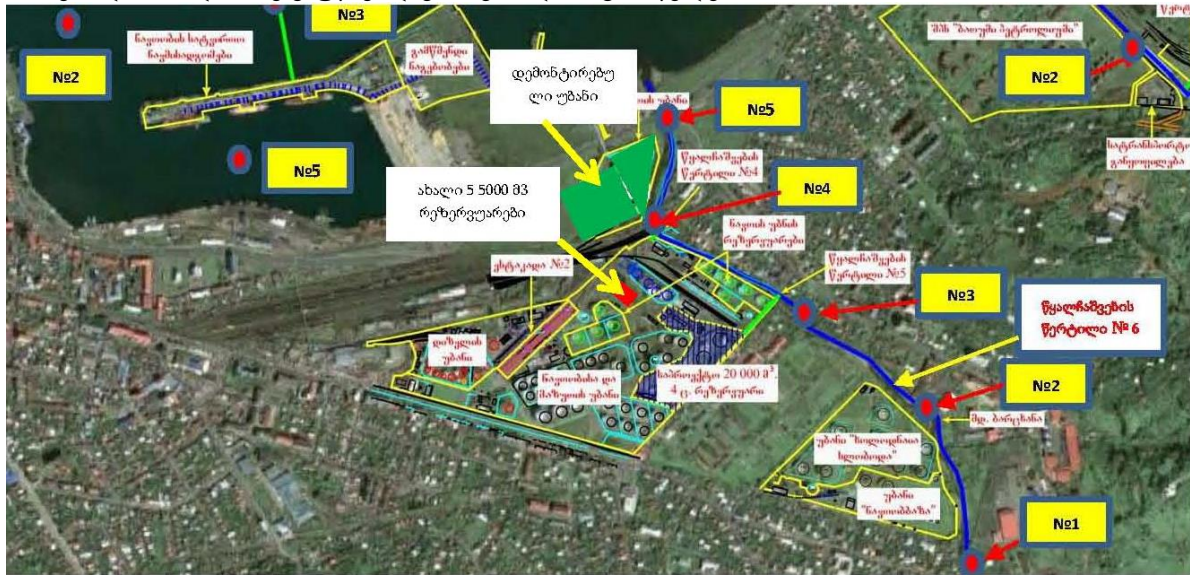
სურათი 9.3.1. მდინარე ბარცხანას მონიტორინგის წერტილები და ბათუმის ნავთობტერმინალის საწარმოო ობიექტებიდან წყალჩაშვების წერტილები №4, №5 და №6
