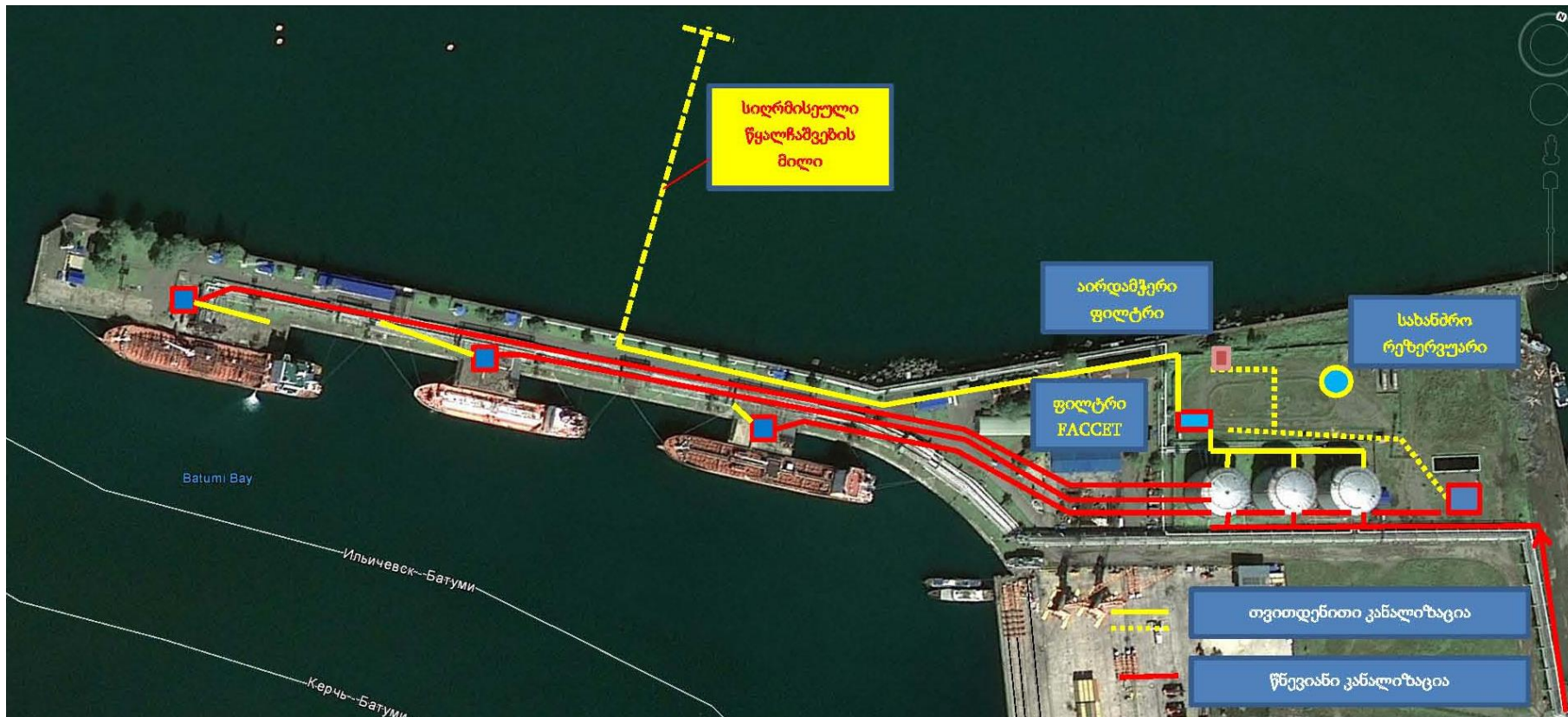
დანართი 17. ნავმისადგომების უბნის კანალიზაციის და წყალჩაშვების წერტილის გეგმა
