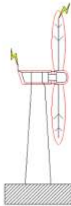
სურათი 4-11 ტურბინაზე მეხის დაცემისას ენერჯის გატარების წირები
