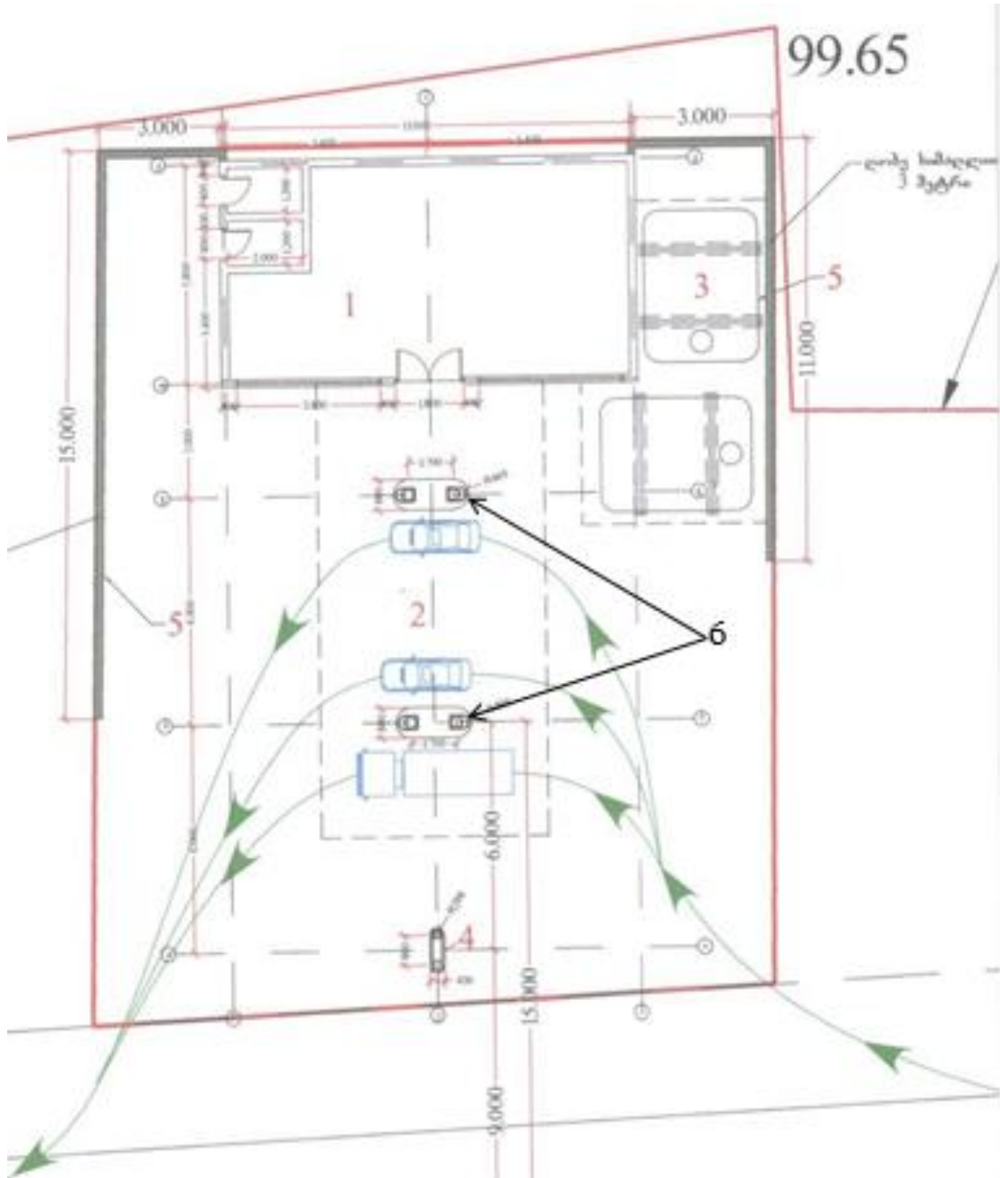
ნახაზი 3. 1-საოპერატორო; 2-ფარდული; 3-ავზები; 4-სარეკლამო ფირნიში; 5-ღობე; 6- საჩამომსხმელო სვეტები
