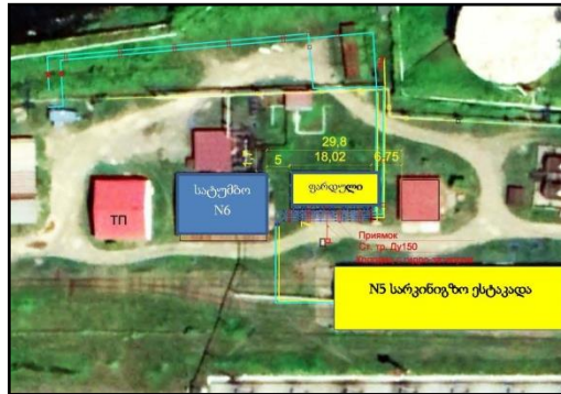
სურათი 4.10.1. სატუმბო სადგურის ფარდელის განთავსების სქემა
