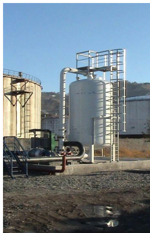
სურათი. 3.16.2.4. აირდამჭერი ფილტრი კაპრემუმის უბანში
