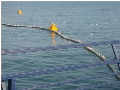
სურათი 3.4.2.1. აირგამწმენდი დანადგარი ნავმისადგომის უბანზე და უნაპირო ნავმისადგომიდან გაფრქვეული აირების გამყვანი მოტივტივე შლანგი
