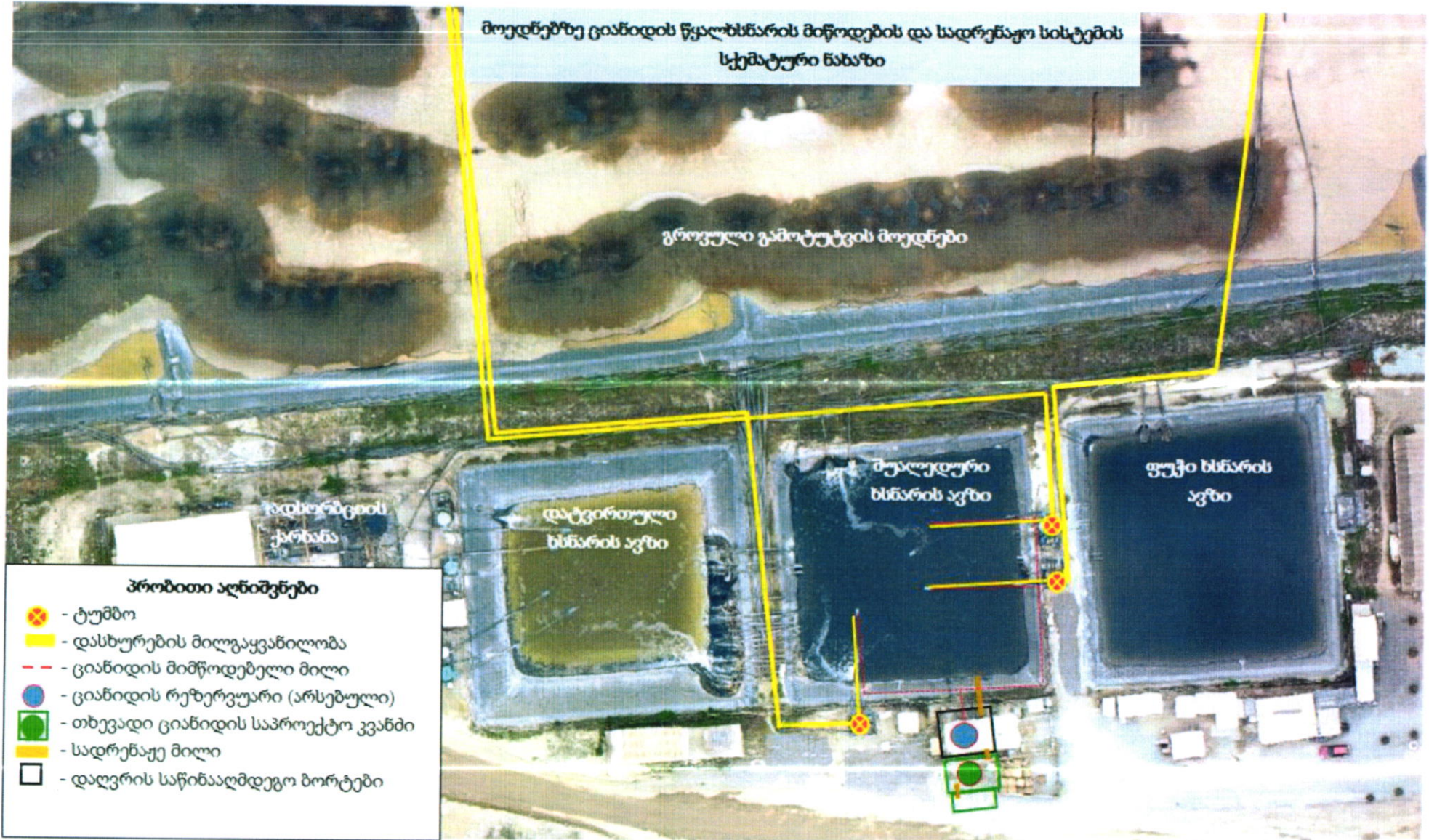
დანართი 2. მოედნებზე ციანიდის წყალხსნარის მიწოდების და სადრენაჟო სისტემის სქემატური ნახაზი
