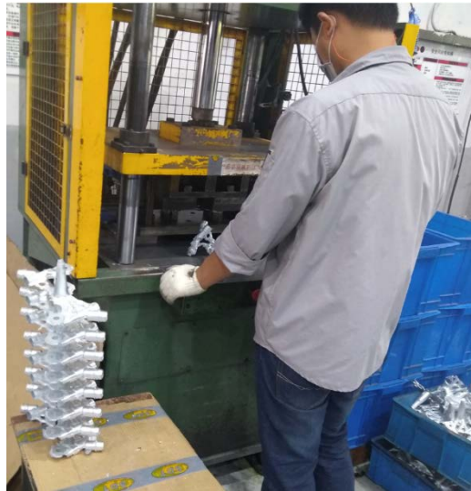
სურათი 4.3.2 საწრფევებელ - სახვრეტი დანადგარი სხმულის ჩამოჭრისთვის
