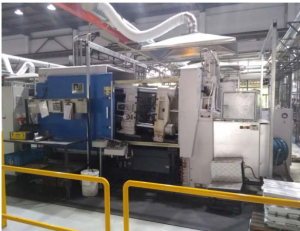
მაღალი წნევის ჩამოსხმის დანადგარი მაღალტემპერატურული კამერით (სადნობი ღუმელი განთავსებულია უშუალოდ დანადგარში)
