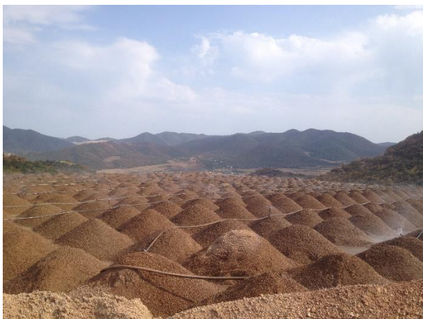
სურათი 1. გამოტუტვა-მეორად კვარციტებზე ნატრიციანიდური ხსნარის დასხურება
