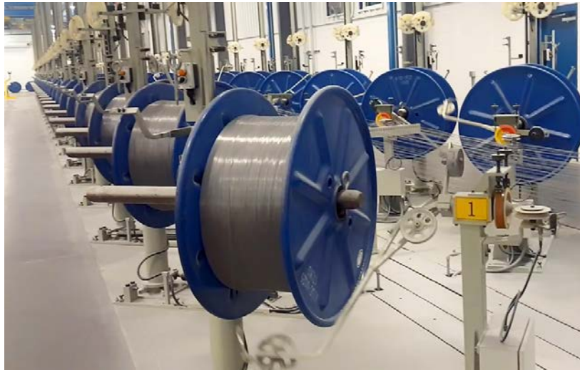
ნახ.4.4 ცხელი მოთუთიებისათვის გამზადებული დაკალიბრებული მავთული.
