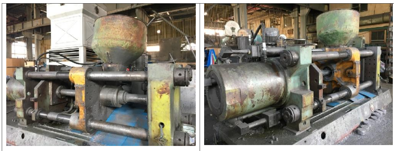
სურათი 4.7.2. დაქუცმაცებული ალუმინის დასაწნეხი დანადგარი (თვითნაკეთობა)
