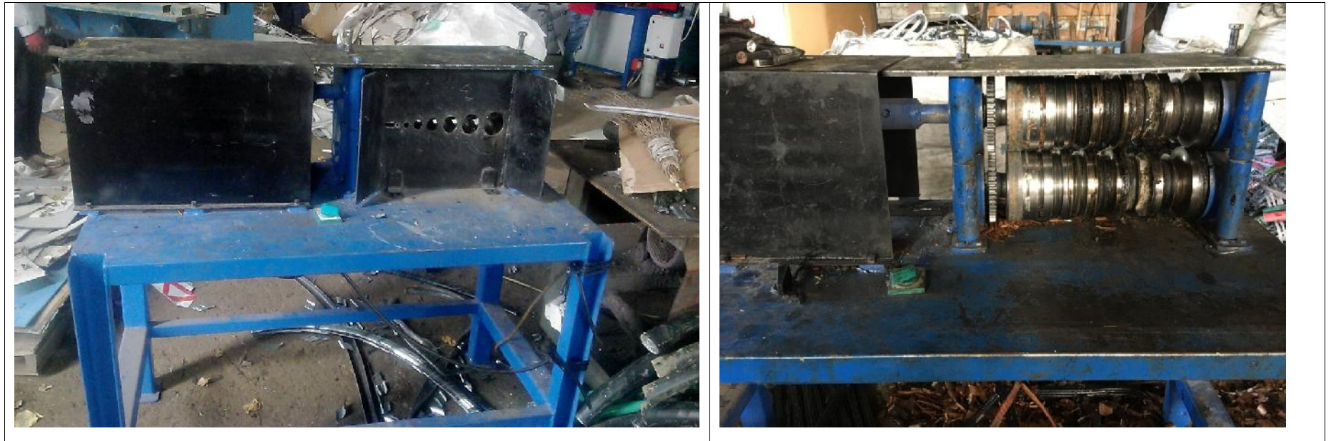
სურათი 4.3.3. ტექნოლოგიურ პროცესებში გამოყენებული ელექტროკაბელის გასაფცქვნიელი დანადგარი (თვითნაკეთი)
