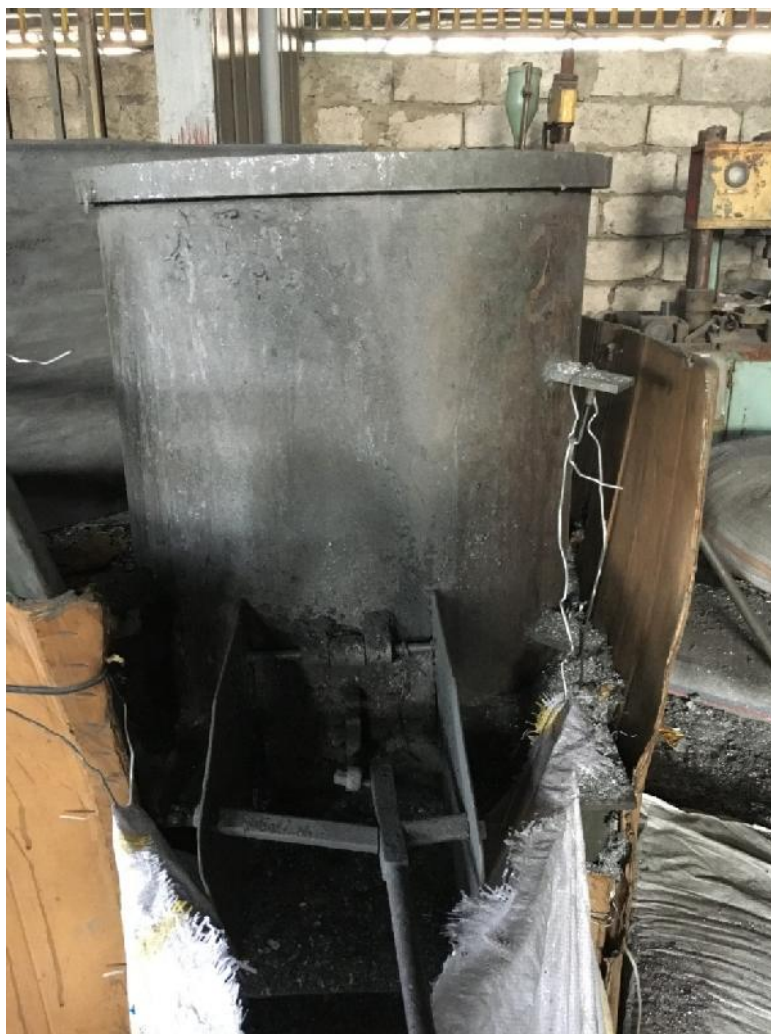
სურათი 4.7.1. ალუმინის ქილის დასაფქვავი დანადგარი (თვითნაკეთი)
