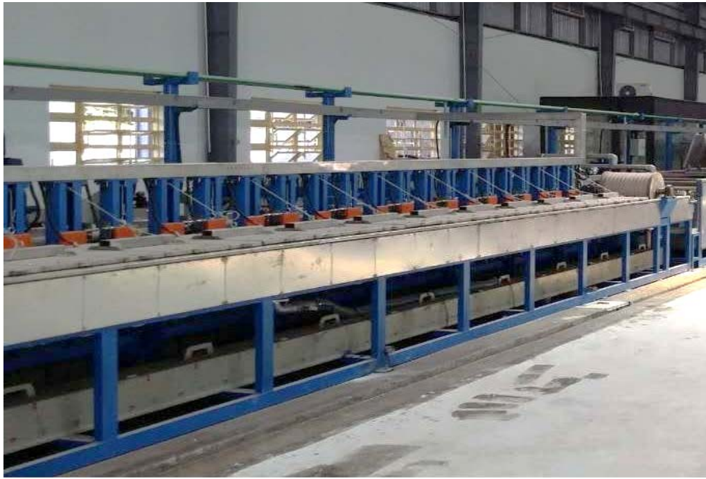
ნახ.4.5 ულტრაბგერით გასუფთავების (ულტრაბგერითი ფოსფატირებისა და ოთხჯერადი რეცხვა) დანადგარი
