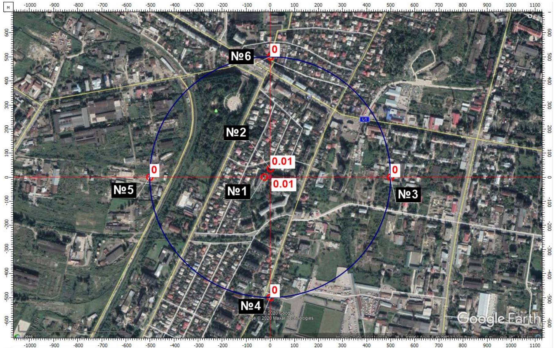
ნივთიერება: 0133 კადმიუმის ოქსიდი. მაქსიმალური კონცენტრაციები უახლოეს დასახლებასთან (წერტ. N1, N2) და ნორმირებული 500მ. ზონის საზღვარზე (წერტ. N3-6).
