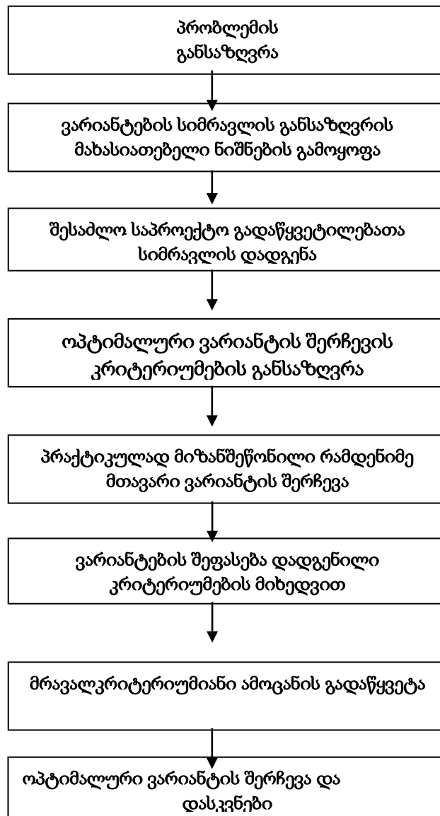
ნახ. 10.1 ალტერნატიული ვარიანტების სისტემური ანალიზის ზოგადი სქემა პროექტის ალტერნატიული ვარიანტების ანალიზი, როგორც წესი, გულისხმობს:
