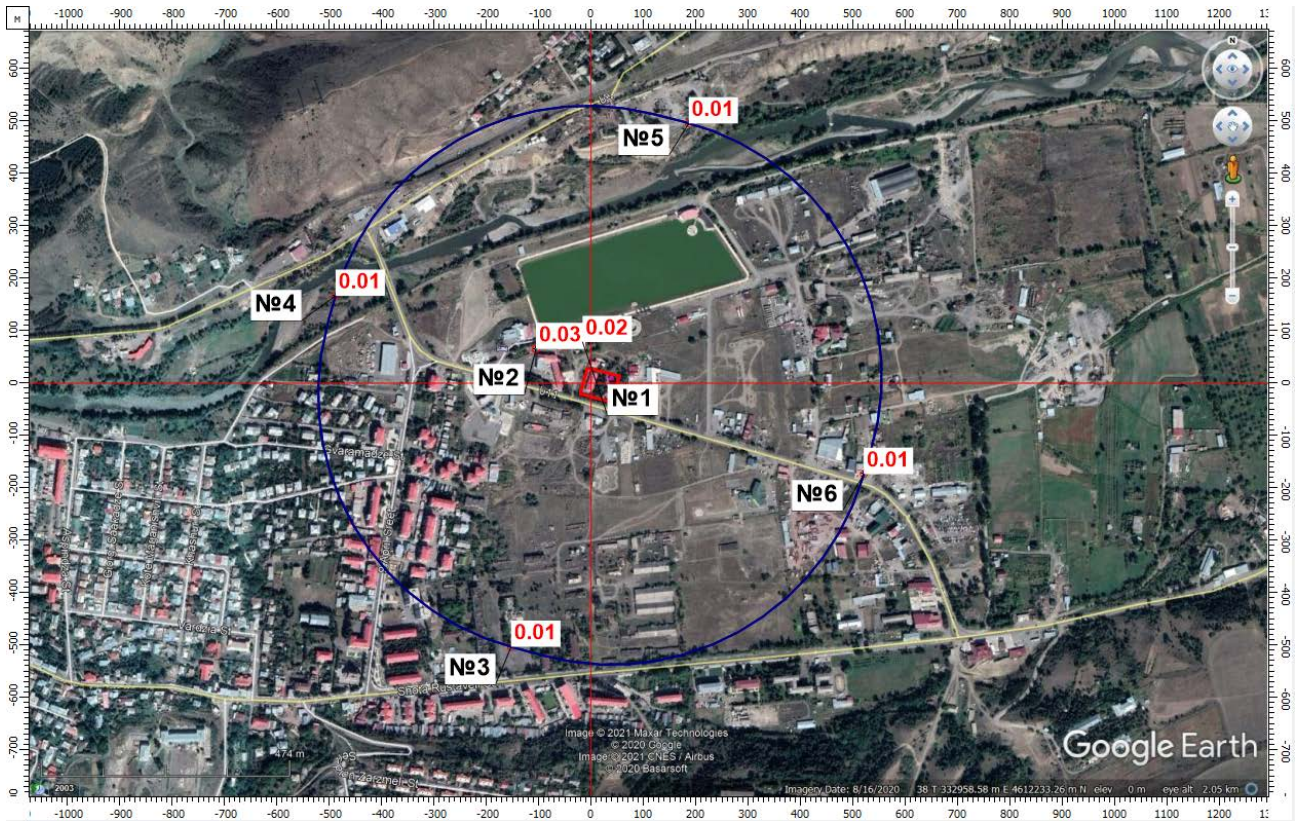
ნივთიერება: 0183 ვერცხლისწყალი (ლითონური ვერცხლისწყალი). მაქსიმალური კონცენტრაციები უახლოეს დასახლებასთან წერტ. N1, N2 და ნორმირებული 500 მ-ის ზონის საზღვარზე წერტ. N3-6.
