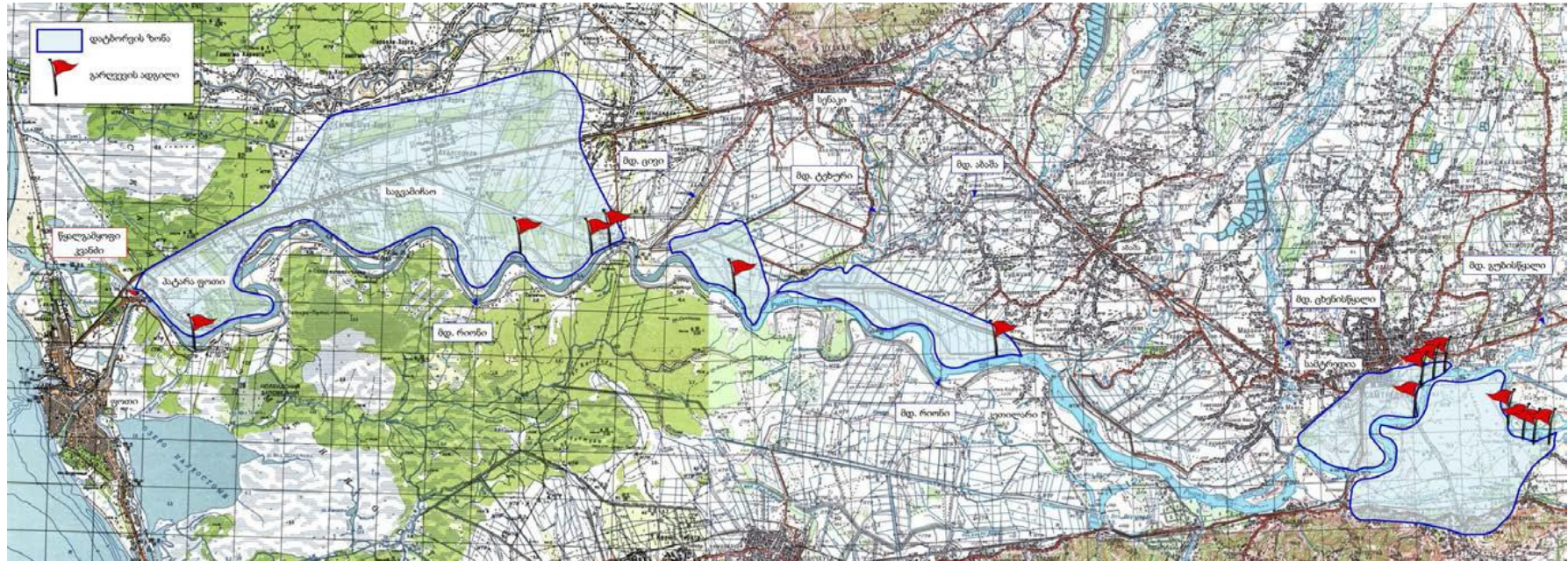
რუკა 2.2.3.3.1.1. მდ. რიონის მიერ 1987 წლის 19-20 იანვარს დატბორილი ფართობები და დამცავი დამბების გარღვევის ადგილები (აღნიშნულია დროშებით)
