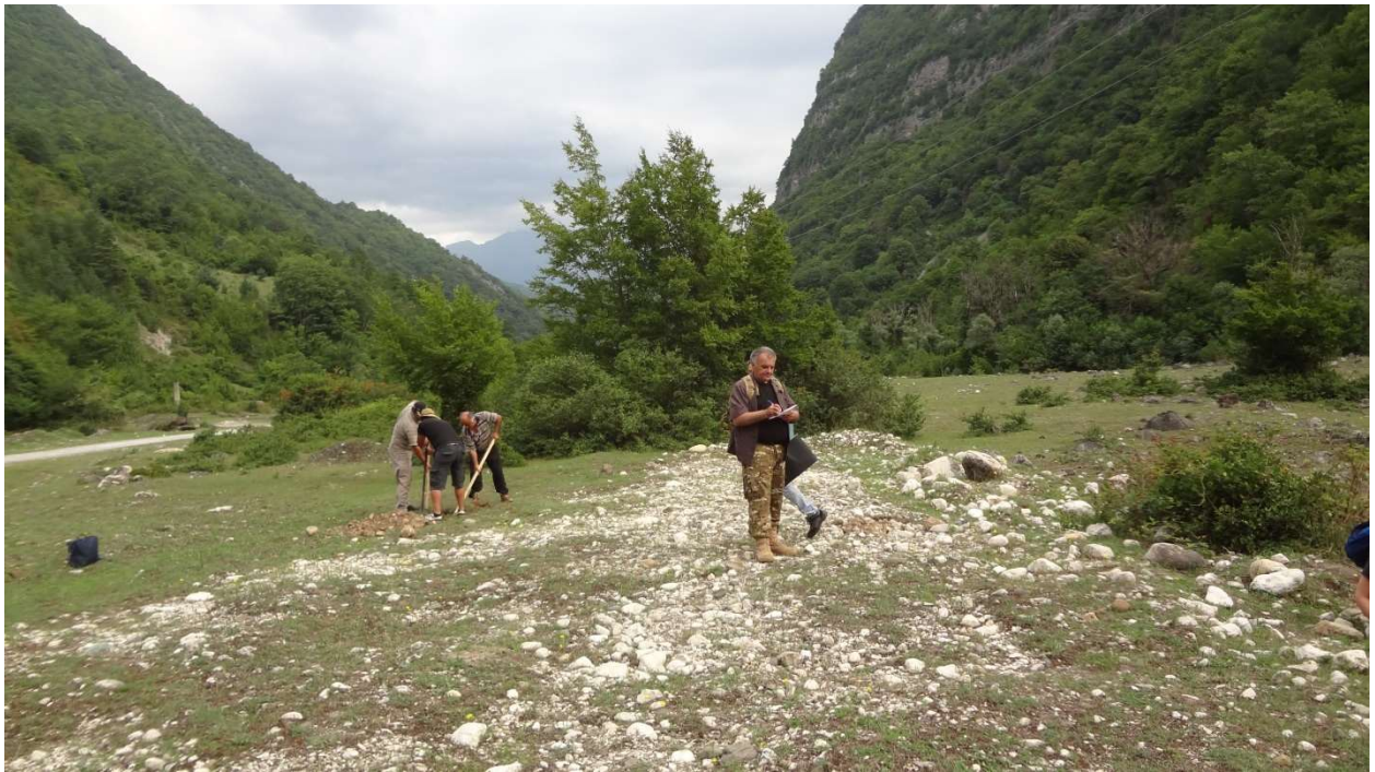
სურათი #1. სამთო სამუშაოები #1 საყრდენის განთავსების ადგილზე. ლითოლოგიურად 0.3 მეტრიდან წარმოდგენილი მდ. ჯონოულის პირველი ტერასის ალუვიური მსხვილნატეხოვანი ნალექებით - კენჭნარით.
