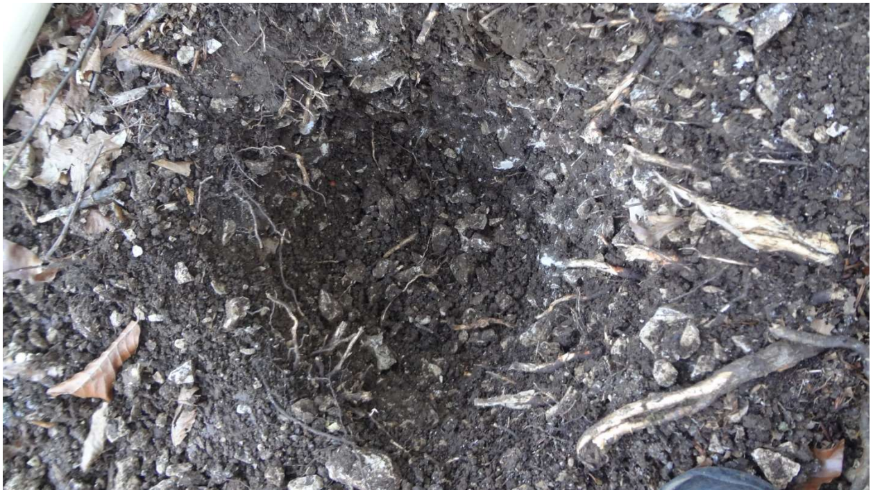
სურათი #5. #5 შურფბურღილის გაყვანის პროცესი, რომელიც ზედაპირიდან წარმოდგენილია გამოფიტული ძირითადი ქანების – კირქვების ნატეხოვანი ზონით.
