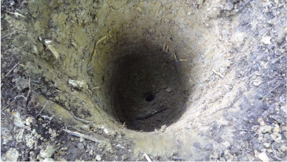
სურათი #27. #27 შურფბურღილის გაყვანის პროცესი. ლითოლოგიურად წარმოდგენილი მოყავისფრო-მოყვითალო ძნელპლასტიკური თიხებით. ადგილის რელიეფი წარმოადგენს აღმოსავლეთიდან დასავლეთით 10-15^{\circ} -ით დახრილ ფერდობს ფართოფოთლოვანი ტყის საფარით.
