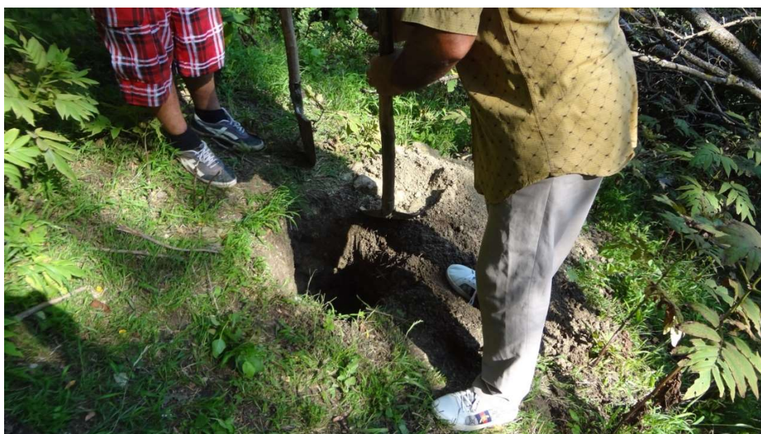
სურათი #14. #14 შურფბურლილის გაყვანის პროცესი. რომელიც 1.2 მ სიღრმიდან ლითოლოგიურად წარმოდგენილია ძირითადი ქანების – კირქვების ნატეხვანი ზონით. მორფოლოგიურად საპროექტო საყრდენი განლაგებულია 35-40° დახრილობის ფერდობის ქვედა ნაწილში.
