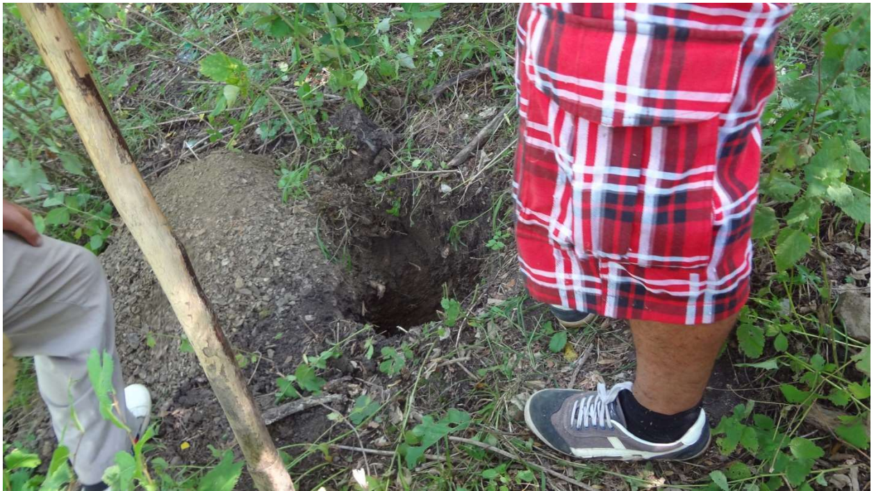
სურათი #17. #17 შურფბურღილის გაყვანის პროცესი, რომელიც ლითოლოგიურად 0.8 მ სიღრმიდან წარმოდგენილია ნახევრად კლდოვანი ქანით – არგილითით. მორფოლოგიურად ადგილმდებარეობა შეესაბამება ფერდობის ზედა ნაწილს, რომელიც დახრილია 30-35°-ით და საკმაოდ მიუდგომელია.
