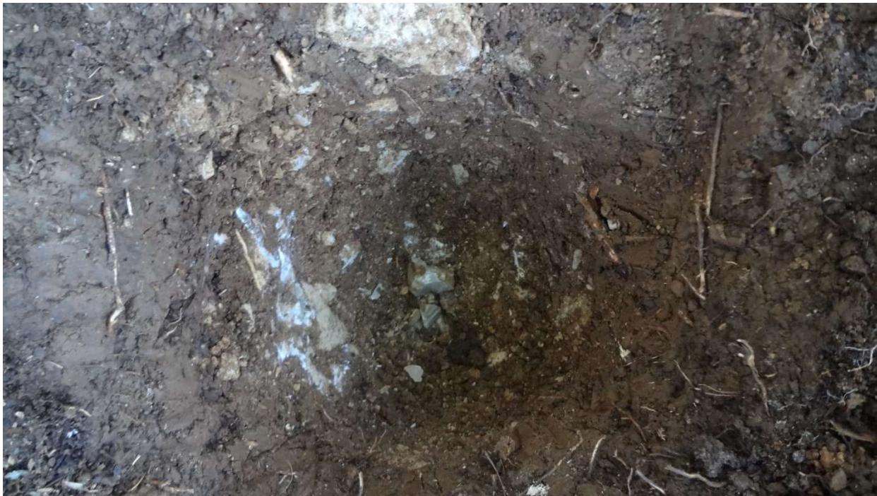
სურათი #7. შურფბურღილის გაყვანის პროცესი #7 საყრდენის განთავსების ადგილზე, რომელიც 0.7 მეტრი სიღრმიდან წარმოდგენილია ძირითადი კლდოვანი ქანების – კირქვის გამოსავალებით.
