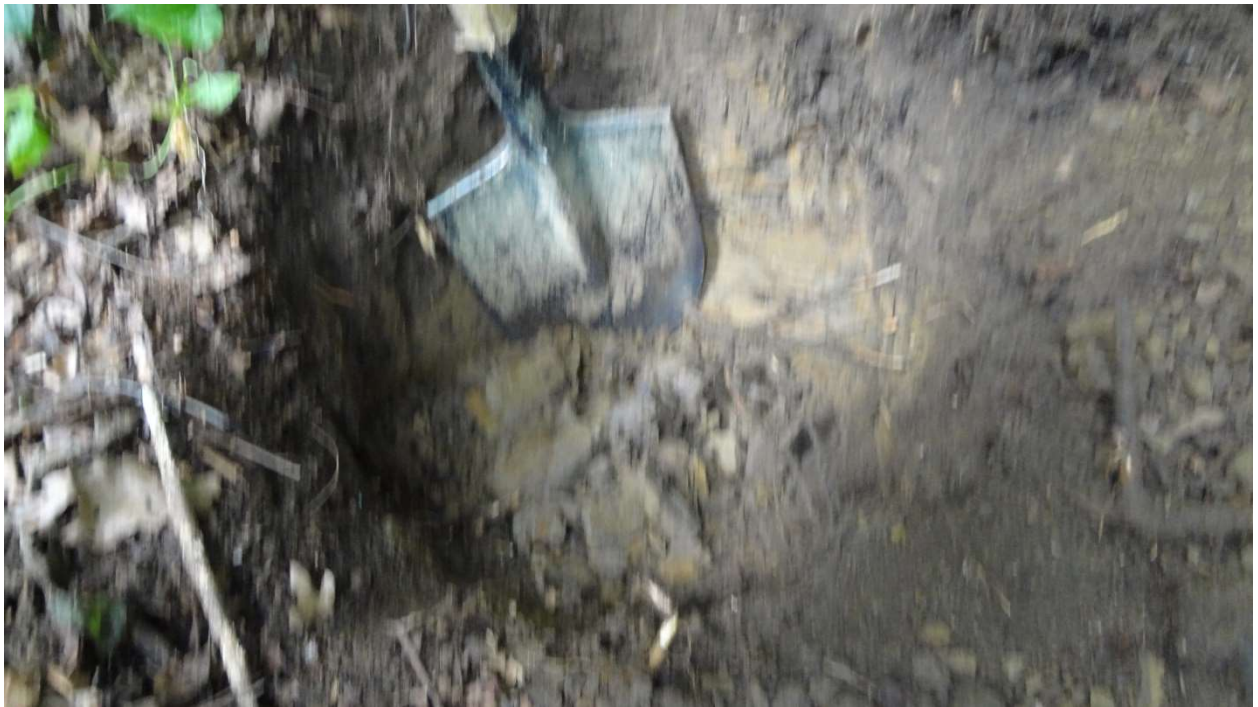
სურათი #21. #21 შურფბურღილის გაყვანის პროცესი, რომელიც 0.5 მ სიღრმიდან წარმოდგენილია კლდოვანი ძირითადი ქანით – ქვიშაქვით. მორფოლოგიურად ის განლაგებულია 35-40° დახრილობის ფერდობის ქვედა ტყიან ნაწილში.
