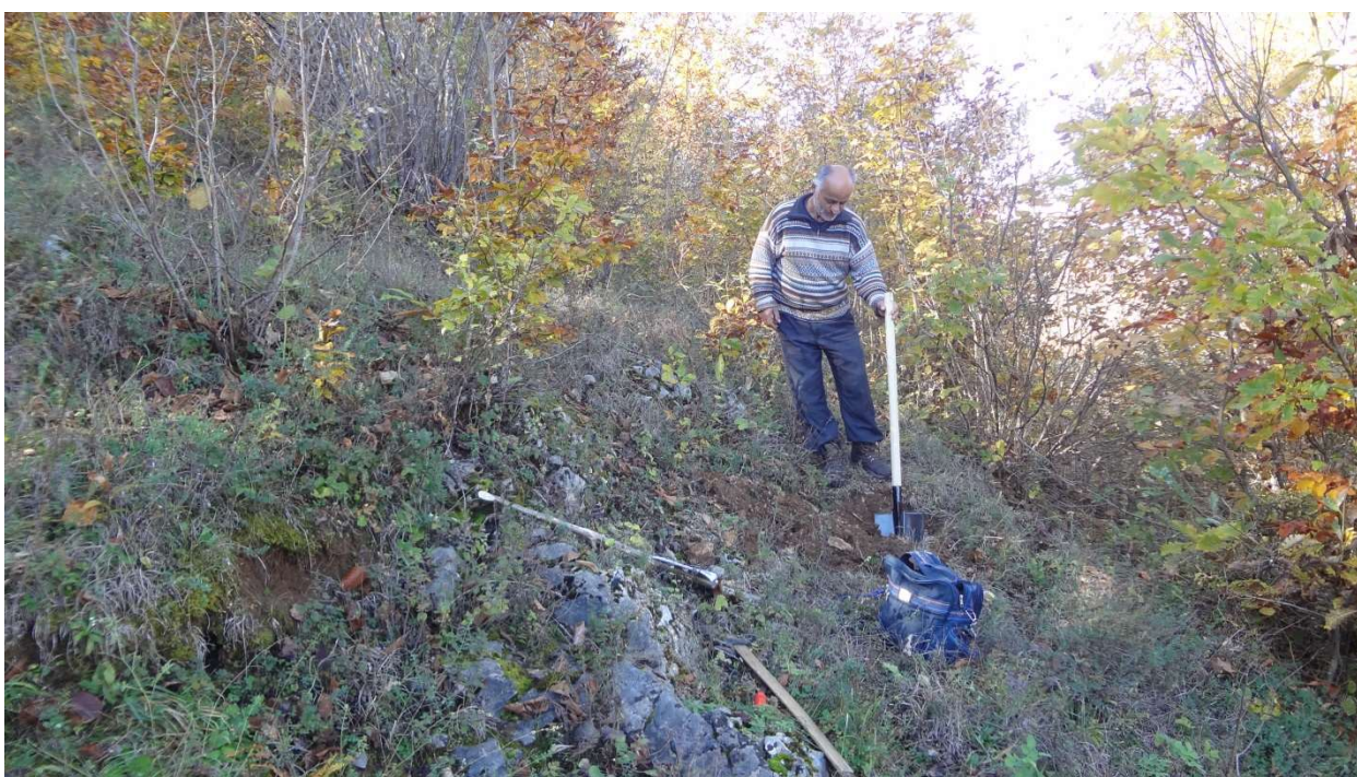
სურათი #8. #8 შურფბურღილის გაყვანის პროცესი. მორფოლოგიურად ის განლაგებულია 28-30° დახრილობის ფერდობის ქვედა ნაწილში, ხოლო ლითოლოგიურად 0.5 მ სიღრმიდან წარმოდგენილია ძირითადი კლდოვანი ქანების კირქვების გამოსავალებით.
