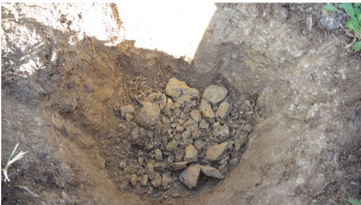
სურათი #40. #40 შურფბურღილის გაყვანის პროცესი. ზედა 0.2 მ-ის გამოკლებით ლითოლოგიურად ის, ფაქტიურად მთელს ჭრილში წარმოდგენილია კლდოვანი ძირითადი ქანით – ქვიშაქვით.
