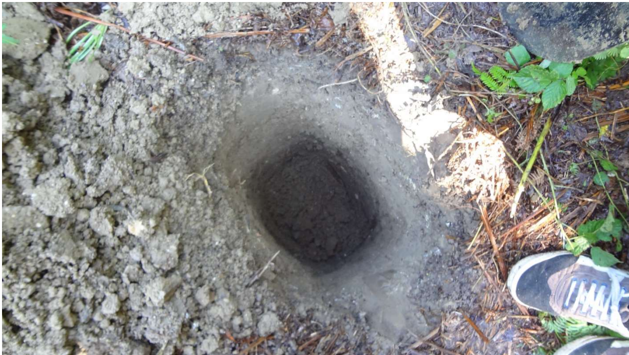
სურათი #23. #23 შურფბურღილის გაყვანის პროცესი. საყრდენის განთავსების ზედაპირი ტერასისმაგვარი ბრტყელი ფორმისაა უმნიშვნელოდ 5-10°-ით საავტომობილო გზისკენ დახრილი. ზემოთკენ მას ტყიანი ფერდობი ემიჯნება. ლითოლოგიური ჭრილი წარმოდგენილია ღია ყავისფერი რბილპლასტიკური თიხნარებით.
