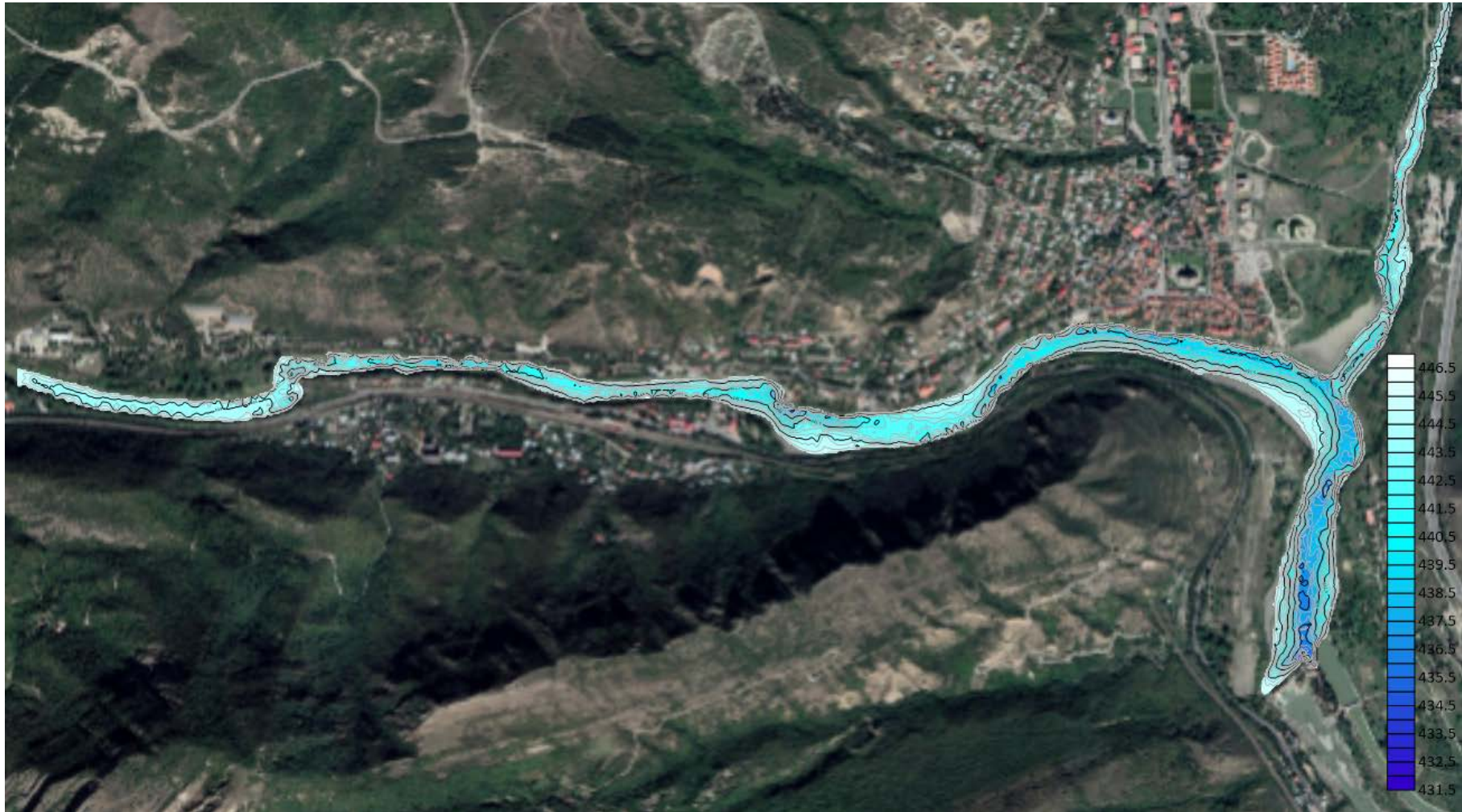
სურათი 5.1.8.1.6. ზაჰესის წყალსაცავის ბათიმეტრული რუკა აეროფოტოზე დატანით
