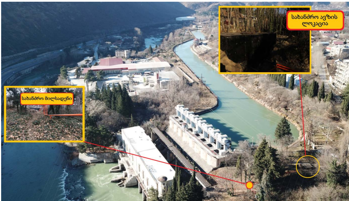
სურათი 4.2.13.2. სახანძრო ავზი, მილსადენი და ჰიდრანტები
