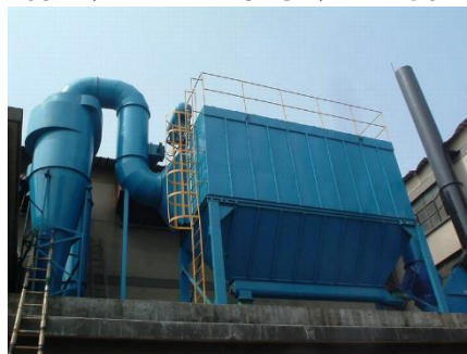
სურათი 5.1.2.1. ცემენტის საწარმოებში გამოყენებული აირგამწმენდი სისტემის ერთე-ერთი მოდელი ფილტრი
