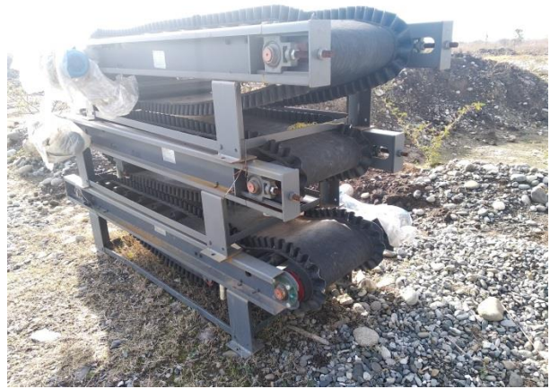
სურათი 3.1.4. დასამონტაჟებელი ლენტური ტრანსპორტიორი
