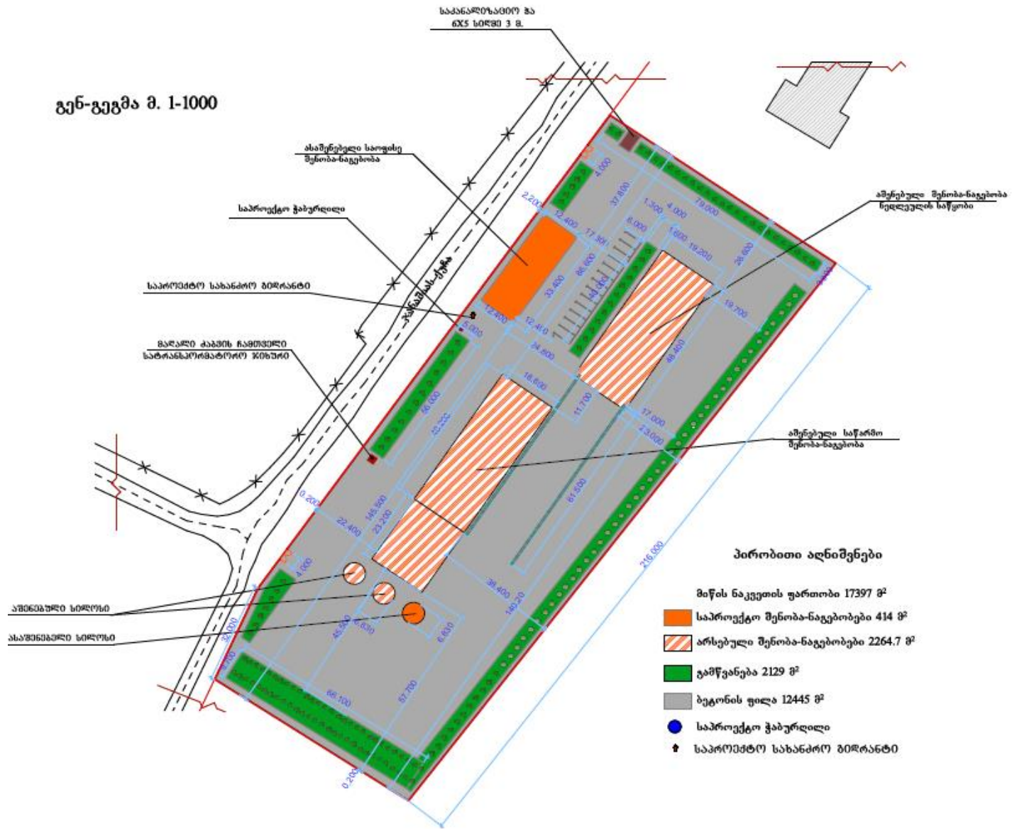
სურათი 3.1.14. შპს „კოლხეთიცემენტი“-ს ცემენტის საწარმოს გენგეგმა - საშენებელი და აშენებული ინფრასტრუქტურის დატანით
