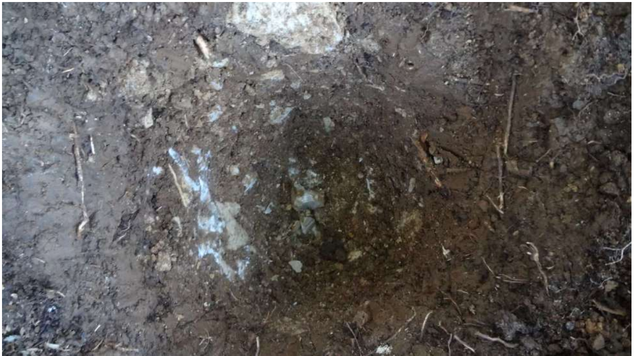
სურათი #7. შურფბურღილის გაყვანის პროცესი #7 საყრდენის განთავსების ადგილზე, რომელიც 0.7 მეტრი სიღრმიდან წარმოდგენილია ძირითადი კლდოვანი ქანების – კირქვის გამოსავალებით.
