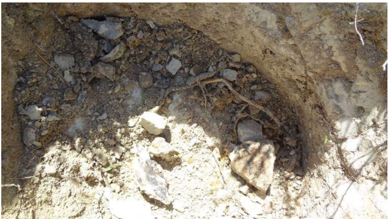
სურათი #38. #38 შურფბურღილის გაყვანის პროცესი. ლითოლოგიურად ის ზედაპირიდან მთელს ჭრილში წარმოდგენილია კლდოვანი ძირითადი ქანით – კირქვით.
