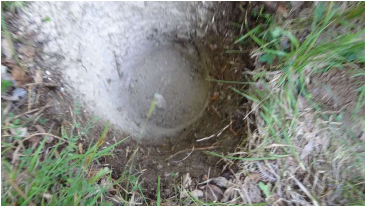
სურათი #37. #37 შურფბურღილის გაყვანის პროცესი, სადაც 0.6 მ-ის სიმძლავრის ნიადაგის ფენის შემდგომ იწყება ძირითადი ქანის – კირქვის გამოსავალები. მორფოლოგიურად ის განთავსდება წყალგამყოფზე, რომლის თხემური ნაწილის სიგანე 50-70 მ-ია, გრძივად დახრილია მდ. რიონის ჭალისკენ 15-25°-ით.
