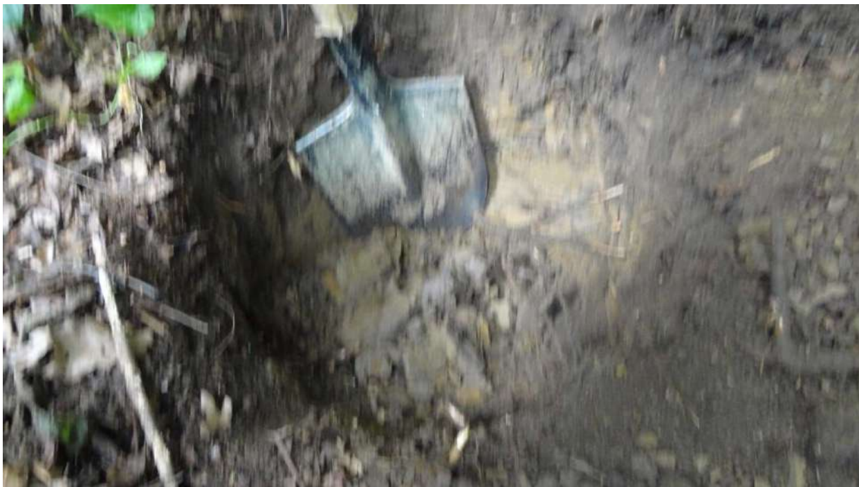
სურათი #21. #21 შურფბურღილის გაყვანის პროცესი, რომელიც 0.5 მ სიღრმიდან წარმოდგენილია კლდოვანი ძირითადი ქანით – ქვიშაქვით. მორფოლოგიურად ის განლაგებულია 35-40° დახრილობის ფერდობის ქვედა ტყიან ნაწილში.
