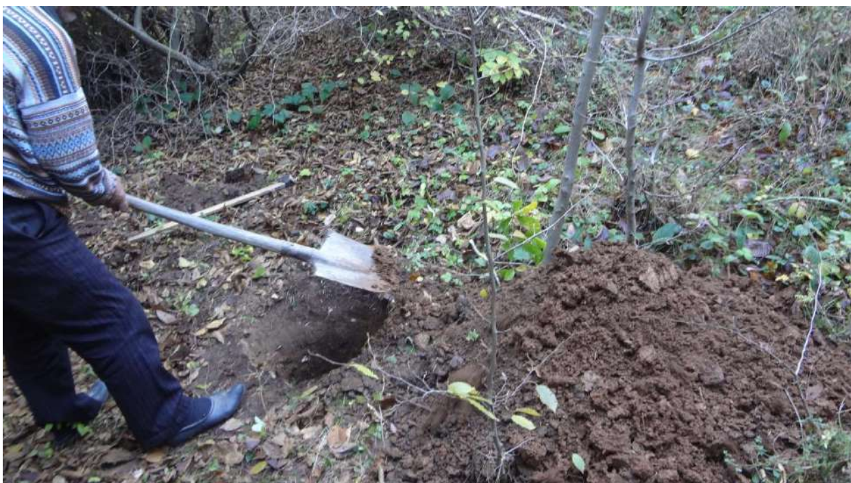
სურათი #6. შურფბურდილის გაყვანის პროცესი #6 საყრდენის განთავსების ადგილზე. რომელიც 0.5 მ სიღრმიდან ლითოლოგიურად წარმოდგენილია მოყვითალო-მოწითალო ფერის ძნელპლასტიკური თიხებით.
