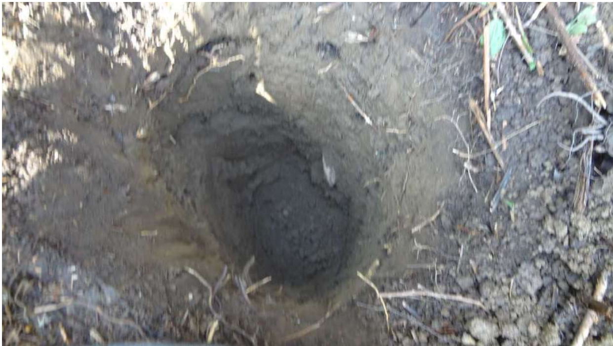
სურათი #19. #19 შურფბურღილის გაყვანის პროცესი, რომელიც განლაგებულია 5-10°-ის დახრილობის ზედაპირზე გვიმრებში, საავტომობილო გზის სიახლოვეს და ლითოლოგიურად წარმოდგენილია ღია ყავისფერი თიხნარებით.
