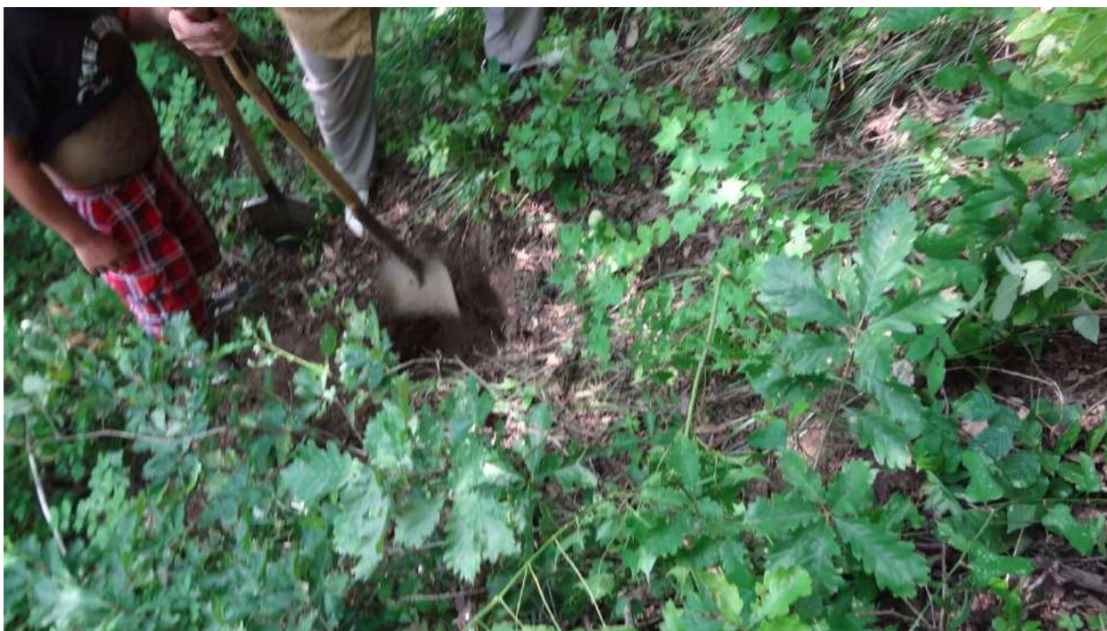
სურათი #20. #20 შურფბურღილის გაყვანის პროცესი 35°-ით დახრილობის, საკმაოდ მწელად ასასვლელ ტყიან ფერდობზე. რომელიც ლითოლოგიურად ზედაპირიდან წარმოდგენილია მყარი კონსისტენციის თიხნარებით.
