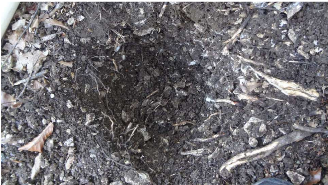
სურათი #5. #5 შურფბურდილის გაყვანის პროცესი, რომელიც ზედაპირიდან წარმოდგენილია გამოფიტული ძირითადი ქანების – კირქვების ნატეხოვანი ზონით.
