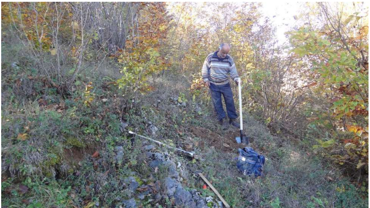
სურათი #8. #8 შურფბურღილის გაყვანის პროცესი. მორფოლოგიურად ის განლაგებულია 28-30° დახრილობის ფერდობის ქვედა ნაწილში, ხოლო ლითოლოგიურად 0.5 მ სიღრმიდან წარმოდგენილია ძირითადი კლდოვანი ქანების კირქვების გამოსავალებით.
