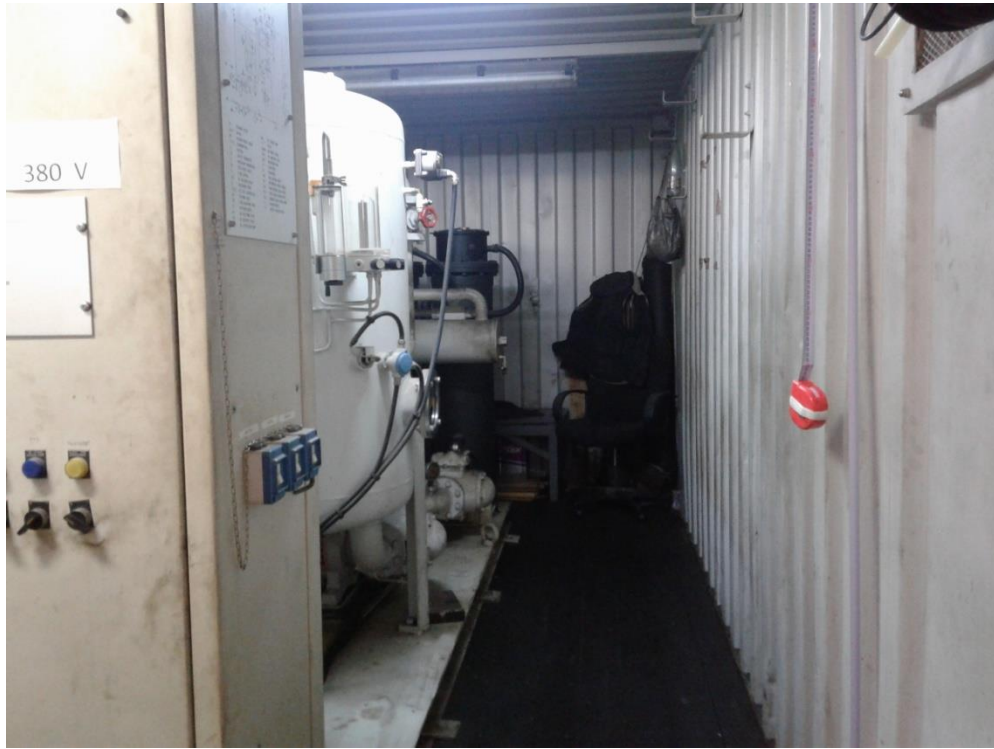
სურ. 2.2.4. დეგაზაცია - შრობა -ფილტრაციის დანადგარი DOV 5002/P
