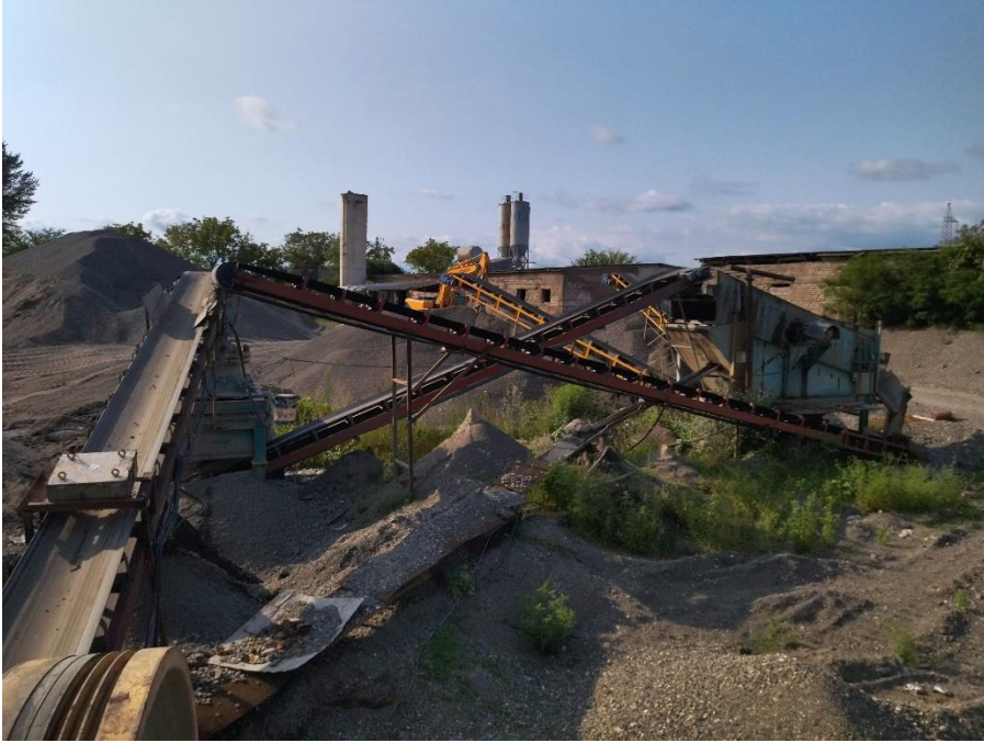
სურათი 4.1. ქვიშახრემის სამსხვრევ-დამხარისხებელი ხაზი.
