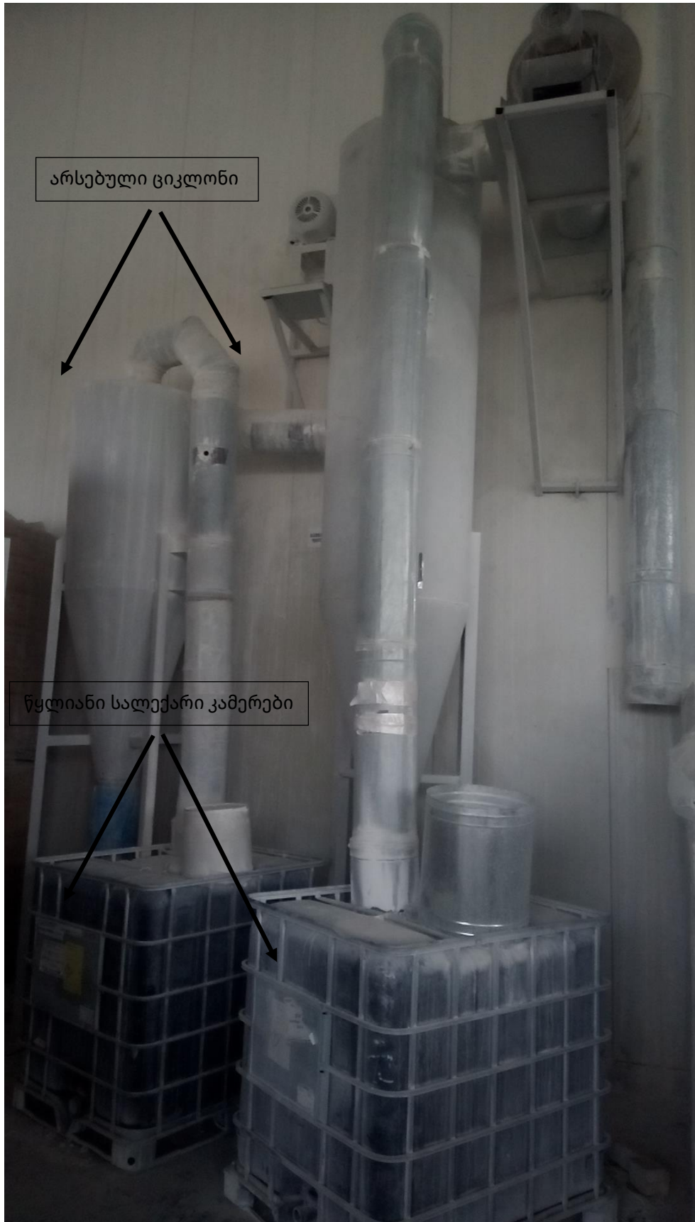
სურათი 1. წყალდისპერსული საღებავების საამქროს ასპირაციული სისტემის ციკლონები და სველი საღებავრები
