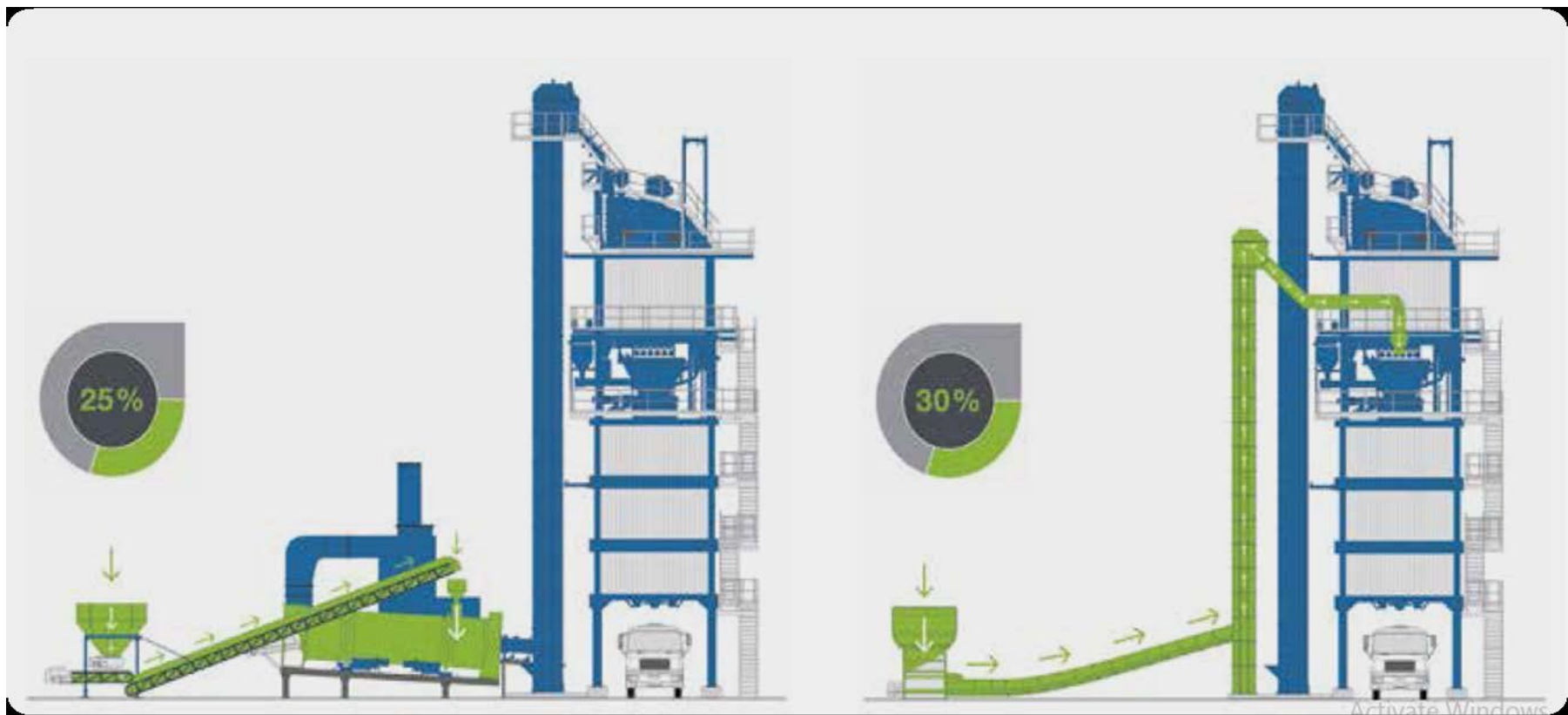
სურათი 2.2.1.1. ასფალტშემრევი BENNINGHOVEN, ECO-4000, დოზირების საშუალო ციკლი და შემრევის პირდაპირი დოზირება
