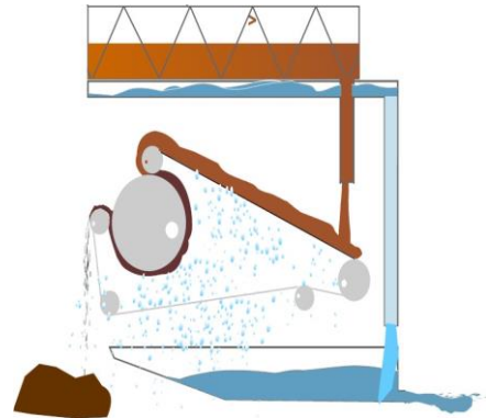
სურ. 15 - ლენტური წნეხის პრინციპული სქემა წინასწარი გაუწყლოვანების მოწყობილობით.
