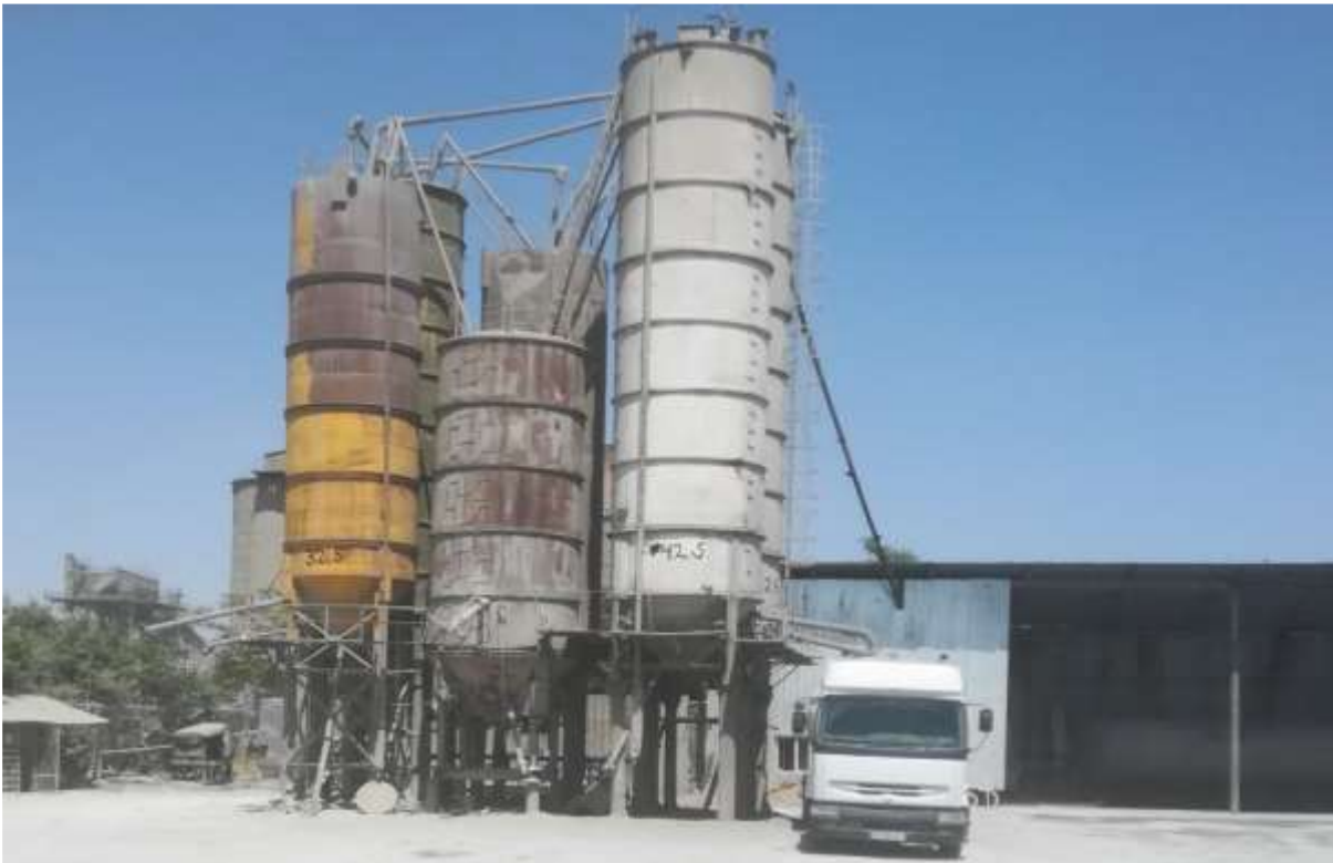
სურ. 3.2.4. ცემენტის სილოსიდან ცემენტის გაცემა ცემენტბზიდში.
