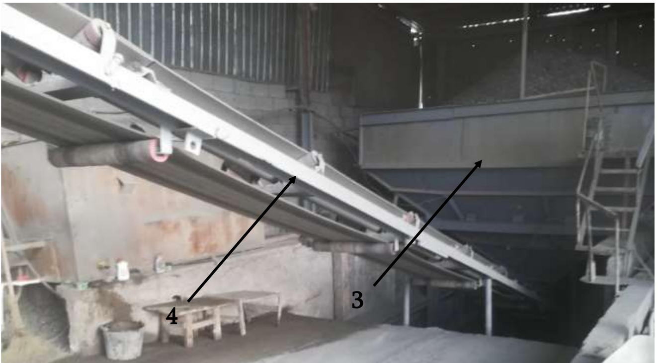
სურ. 3.2.2. ნედლეულის მიმღები ბუნკერი და ლენტური ტრანსპორტიორი.
