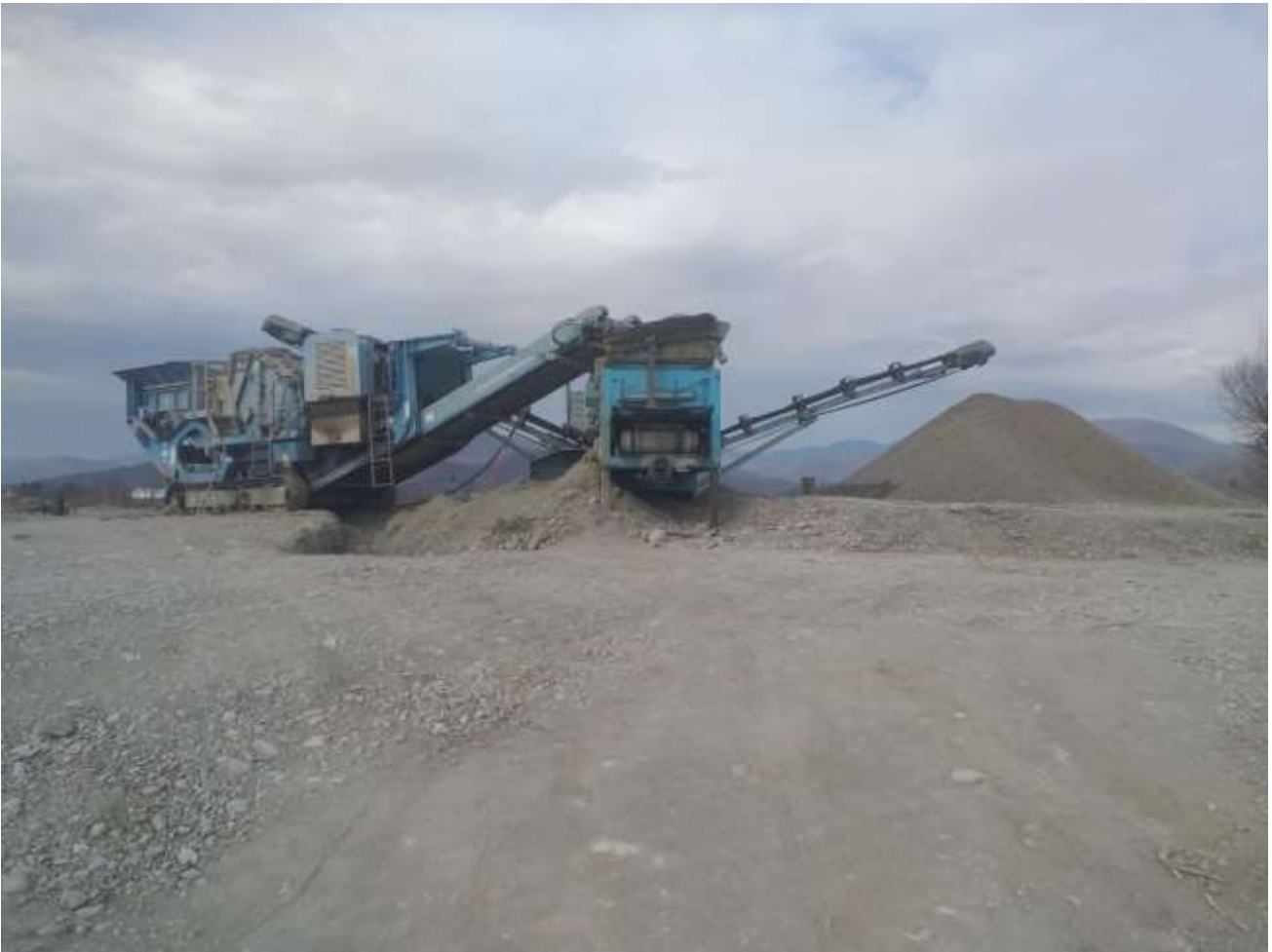
სურათი 2.1. მობილური ინერტული მასალების სამსხვრევ-დამახარისხებელი დანადგარი.
