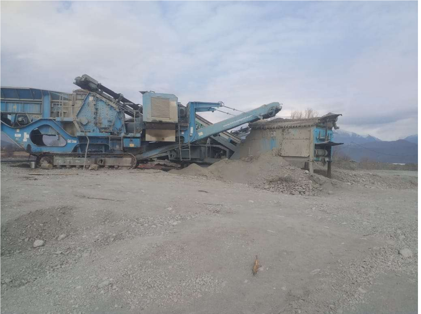
სურათი 2.2. მობილური ინერტული მასალების სამსხვრევ-დამახარისხებელი დანადგარი.
