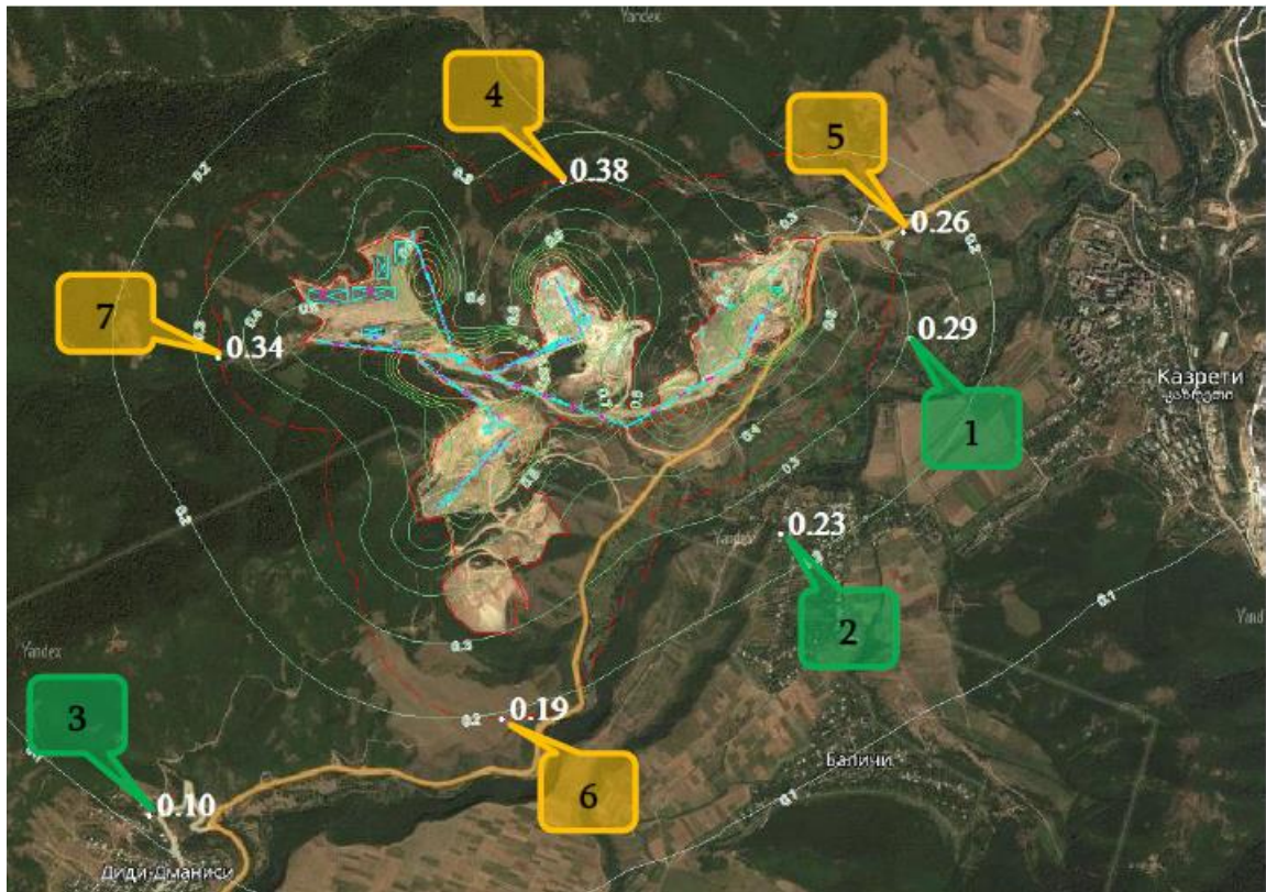
არასრული ჯამური ზემოქმედების 6009 ჯგუფის (კოდები 301 + 330) მაქსიმალური კონცენტრაციები საკონტროლო წერტილებში (№№ 1-3 უახლოეს დასახლებებთან, №№ 4-7 ნორმირებული 500 მ-ნი ზონის საზღვარზე)
