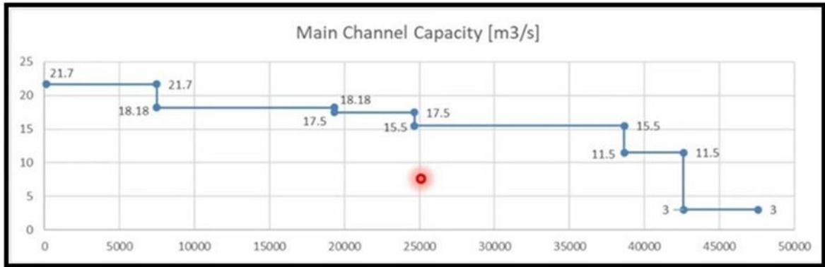
სურათი 5. ქვემო სამგორის მარცხენა მთავარი არხის განივი კვეთის გამტარუნარიანობა 5
